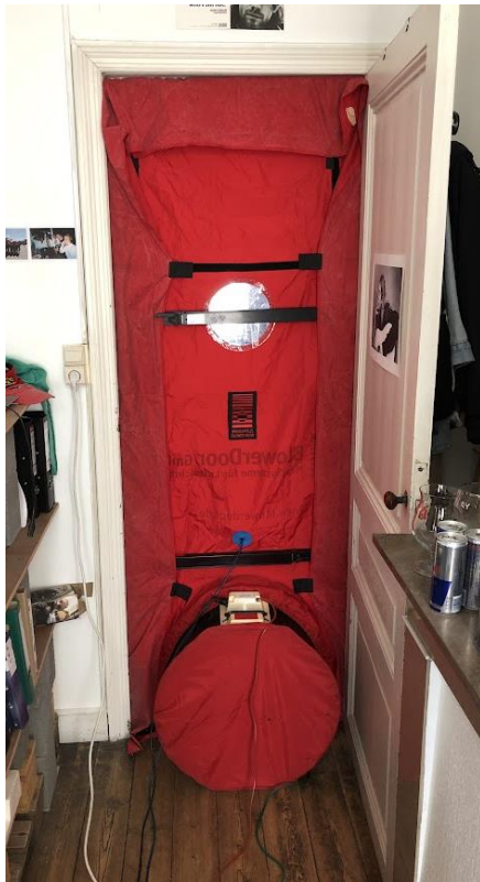
Figuur 8: Uitvoering blowerdoortest
