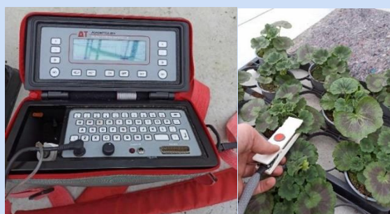
Figuur 6: AP4 porometer in de praktijk (bron: Auteur).
