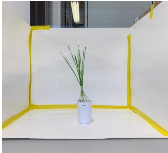
Figuur 5. Zelf gebouwd spraykamer met bench protective paper
