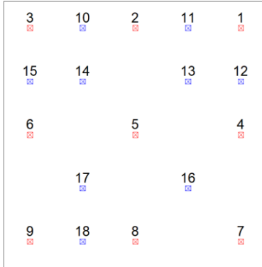
Figuur 3: Ideale opstelling GCP's (rood) en CP's (blauw)
