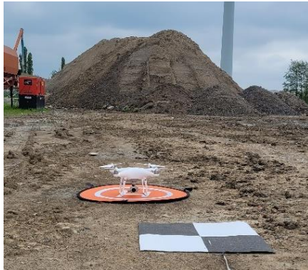
Figuur 4: Land- en opstijgopstelling samen met controlepunt
