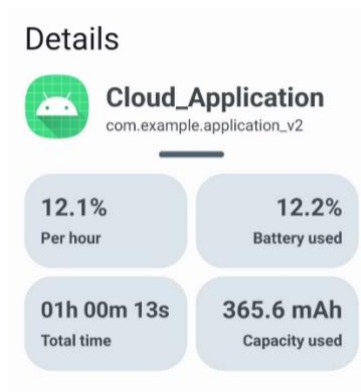
Figuur 88: Meetresultaten cloud-architectuur (tweede netwerk), scenario waarbij elke de data elk uur wordt verwerkt.
