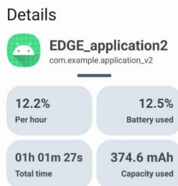
Figuur 85: Meetresultaat batterijconsumptie edge-architectuur, scenario waarbij elke de data elk uur wordt verwerkt.
