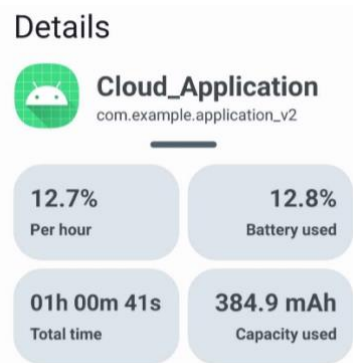
Figuur 87: Meetresultaten cloud-architectuur (tweede netwerk), scenario waarbij elke de data elke vijf minuten wordt verwerkt.
