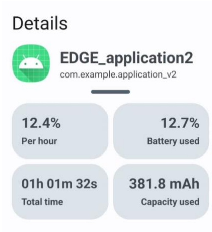
Figuur 83: Meetresultaat batterijconsumptie edge-architectuur, scenario waarbij elke de data elke zes seconden wordt verwerkt.
