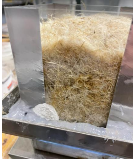
Figuur 54: Zoutkristallisatie aan buitenoppervlak plexiglas
