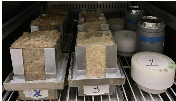
Figuur 36: Alle cups van tweede meetcampagne in klimaatkast
