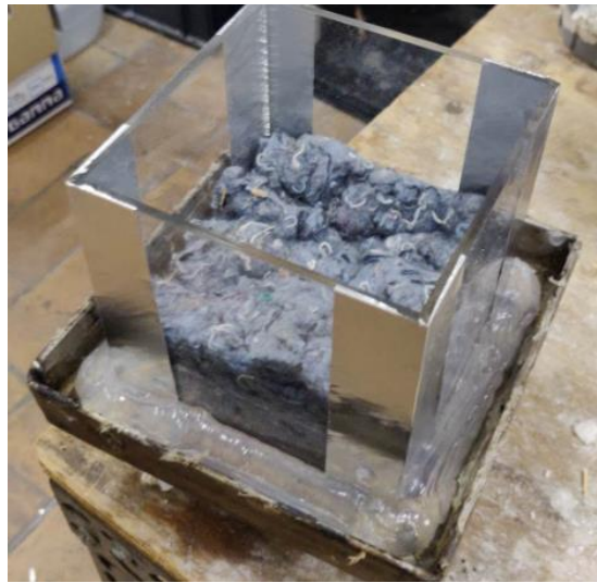
Figuur 24: Afgewerkte cup met katoenisolatie
