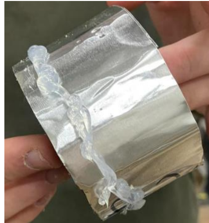
Figuur 30: Silicone op aluminiumfolie van de kurkisolatie
