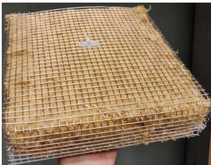
Figuur 11: Op maat gesneden isolatiemateriaal in gaas
