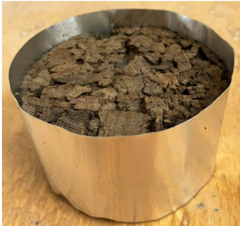
Figuur 29: Klevende aluminiumfolie rond kurkisolatie
