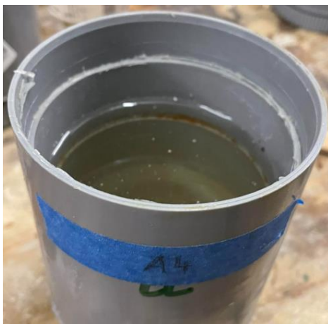
Figuur 33: PVC-buis gevuld met KNO 3 -oplossing
