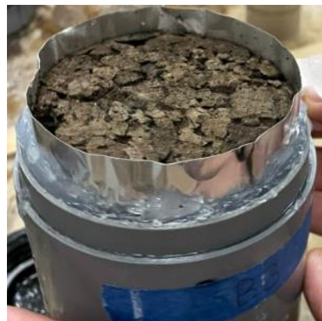
Figuur 34: PVC-buis met opzetstuk voorzien van kurkisolatie
