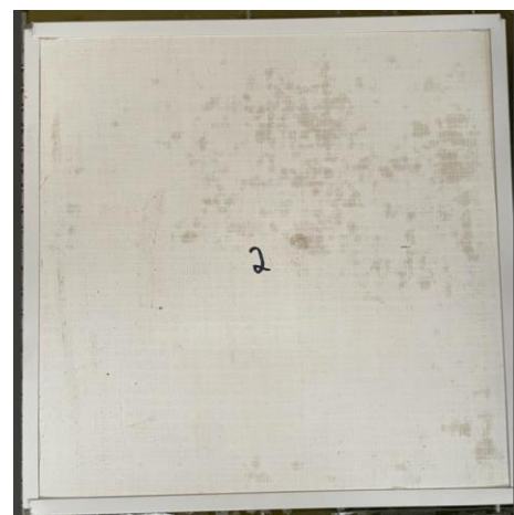
Figuur 50: Waterabsorptie magnesiumoxide 2 met ruwe kant onderaan
