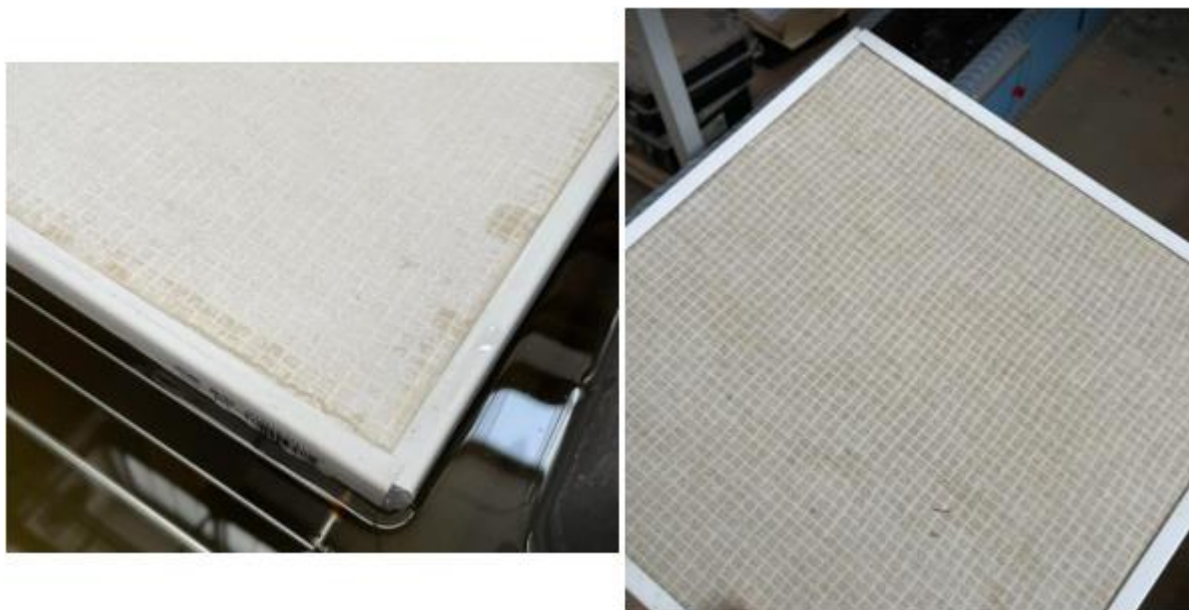
Figuur 13: Magnesiumoxideplaat na bevestiging U-profielen voor ééndimensionale waterabsorptie
