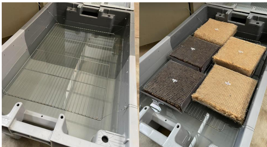
Figuur 15: Proefopstelling capillaire absorptietest zonder en met samples
