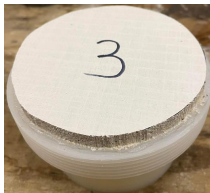
Figuur 27: Kunststofcup met MgO-plaat bevestigd met laagje silicone
