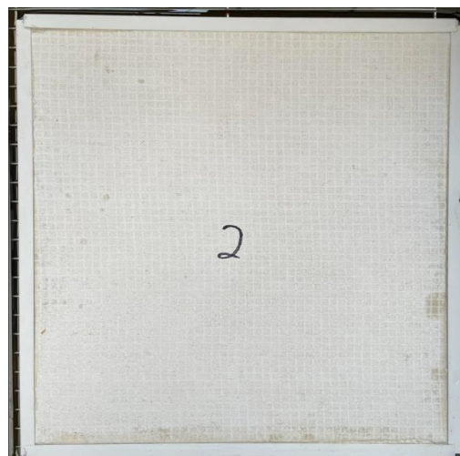
Figuur 52: Waterabsorptie magnesiumoxide 2 met ruwe kant bovenaan
