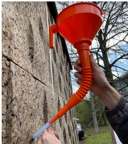
Figuur 40: Bevochtiging van 0,5 l water via flexibel buisje
