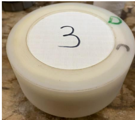
Figuur 28: Kunststofcup met deksel en MgO-plaat
