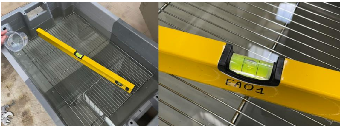
Figuur 14: Waterpas ophangstelsel capillaire absorptietest
