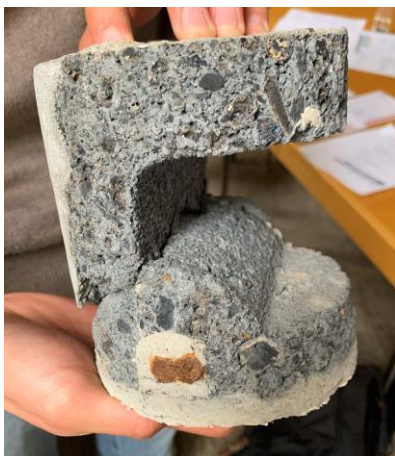
Figuur 52: Kernboring welfsels beton met assen te Viermeersen (Desmeyer, 28/04/2023)
