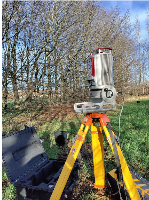
Figuur 3.2: De RIEGL VZ-400i scanner die in UP-positie klaar staat om te scannen.
