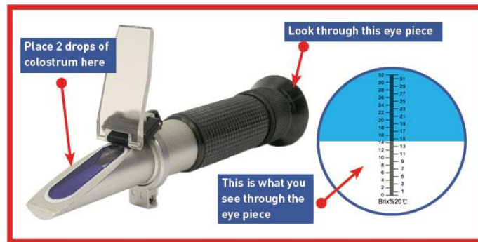
Figuur 3 Wanneer men door de lens kijkt, kan een tabel afgelezen worden 8
