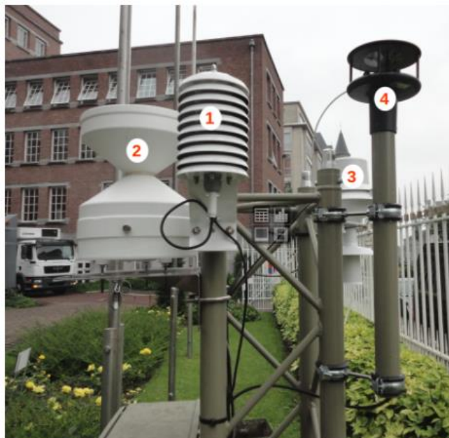
Figuur 4.7: Een overzicht van de verschillende sensoren op een weerstation: passief geventileerd stralingsschild (1), opvangbassin voor de neerslag (2), actief geventileerd stralingsschild (3) en ultrasone anemometer (4) (Mocca, 2020)
