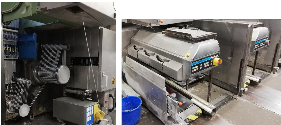
Figuur 8 : Spindels (links) & Wikkelaars (rechts)
