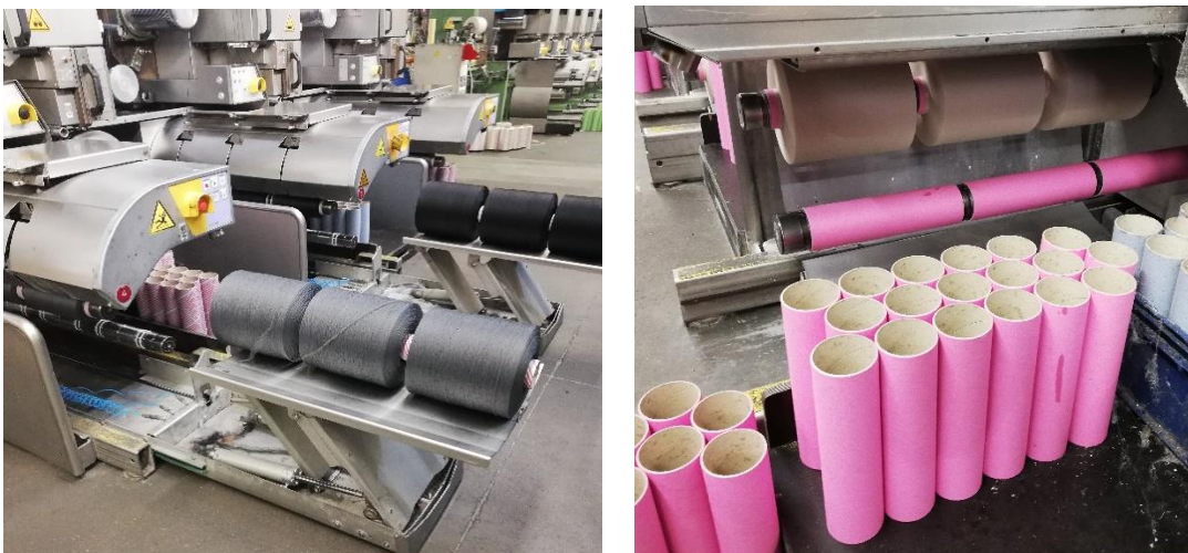
Figuur 10: Gewikkelde bobijnen (links) & Kokers (rechts)
