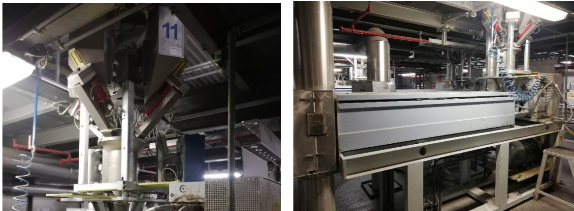
Figuur 6: Hopper (links) & Schroef extrusie (rechts)
