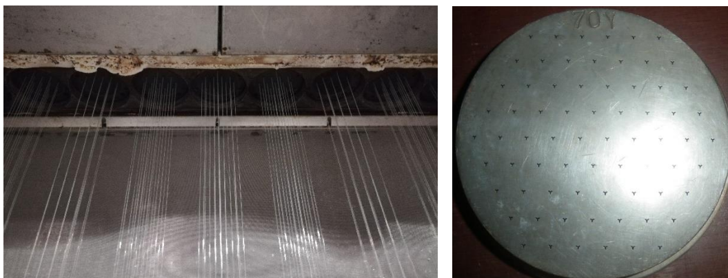
Figuur 7: Rij spinplaten in gebruik (links) & Spinplaat (rechts)
