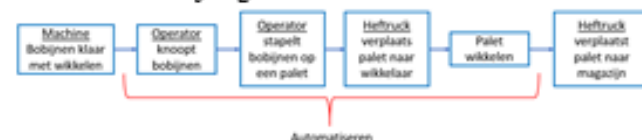
Figure 2: procesbeschrijving extrusie afdeling
