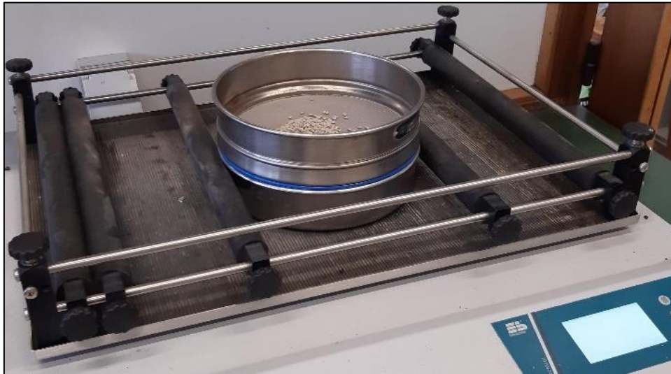
Figuur 23: Opstelling van de wrijvingstest. De zaden werden in een zeef op een schudder geplaatst gedurende 30 minuten aan 300 rpm. Het verschil in de massa voor en na het schudden wees uit hoeveel coating verloren ging tijdens dit proces.
