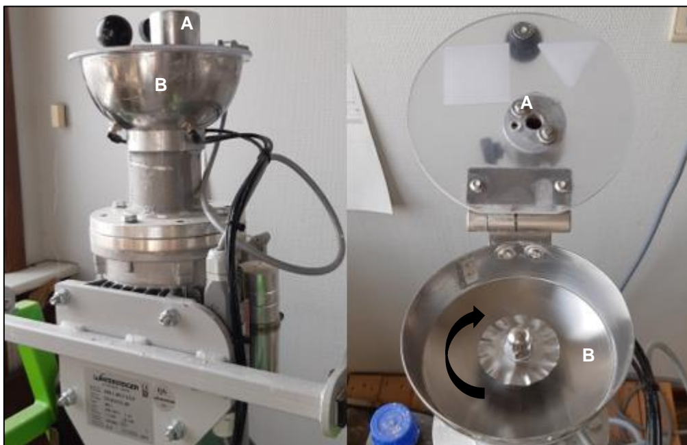
Figuur 20: Coatingmachine aanwezig in het labo (Wintersteiger AG, 2018). Links: zij aanzicht. Rechts: bovenaanzicht. A: holte voor applicatie van carrier en sticker tijdens rotatie. B: Zaadruimte.
