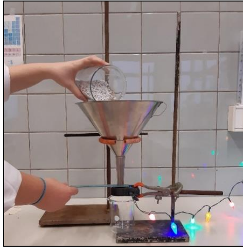
Figuur 24: Opstelling van de flowability-test. De zaden werden in een trechter gegoten en vloeiden daarna langs een sensor die mat hoelang het duurt vooraleer alle zaden de sensor waren gepasseerd.
