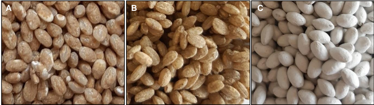
Figuur 37: Resultaat van verkenningstestjes waarbij rhamnolipiden op verschillende manieren in de zaadencrustering werden gebracht. A: rhamnolipiden in carrier, B: rhamnolipiden in slurry en C: rhamnolipiden in sticker. A en B geven een zeer slecht opbouwrendement waardoor de coating niet consistent aanwezig is op de zaden. C voldoet aan alle kwaliteitscriteria.
