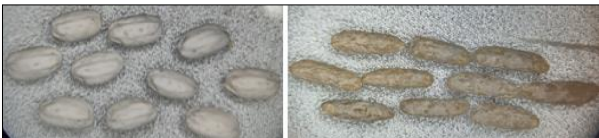
Figuur 22: Voorbeelden van oppervlakken van zaadencrusteringen. Links: 100% bedekt, rechts: 60% bedekt.
