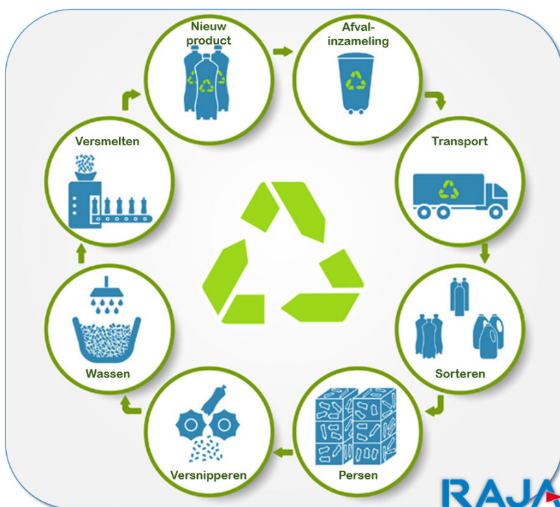
Figuur 2. Mechanisch recyclageproces van bijvoorbeeld PET-flessen 14
