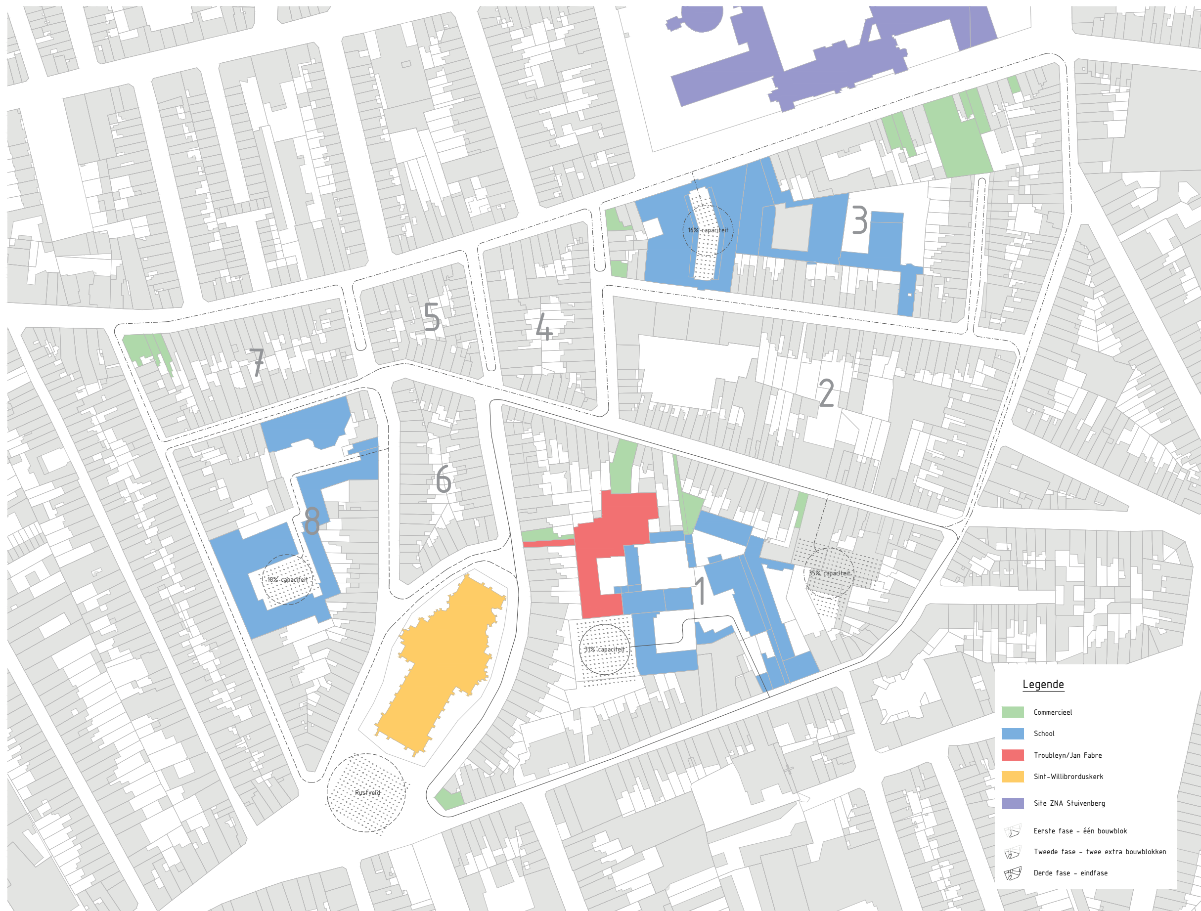
Tekening 13: integratie van het warmtenet en de BE0-velden
