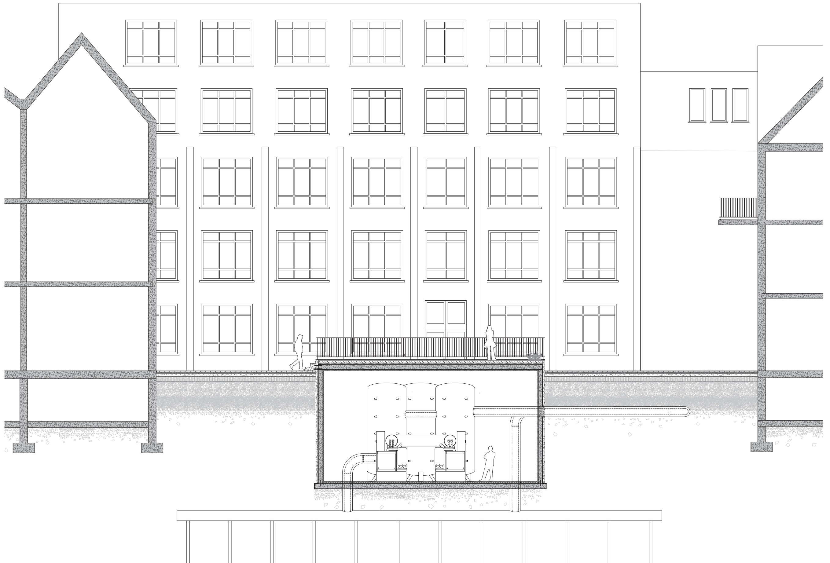
Tekening 14: snede met de integratie van twee warmtepompen en drie buffervaten in een nieuwe technische ruimte (Sint-Mariacollege)
