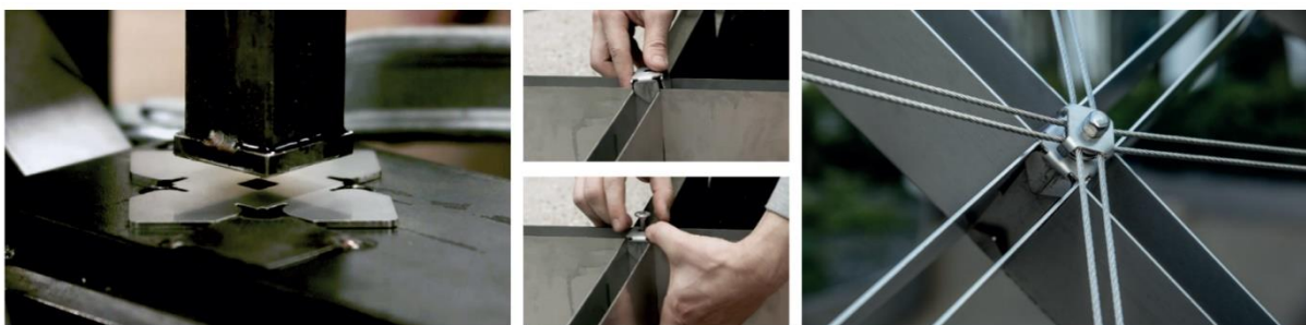
Figuur 8-6: Opbouw van de verbindingen (bron: Felix Noe)
