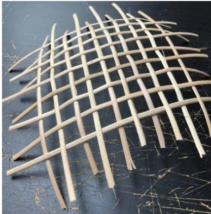
Figuur 6-12: Vervormen van een geweven raster uit pitriet tot een hyparschaal
