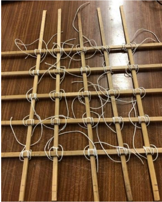
Figuur 7-18: Maquette met kruissjorverbindingen
