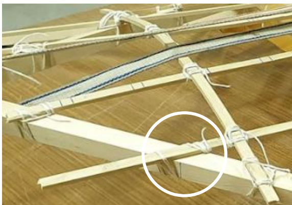
Figuur 6-42: Te losse verbindingen aan de ringbalk met monoclastisch latwerk
