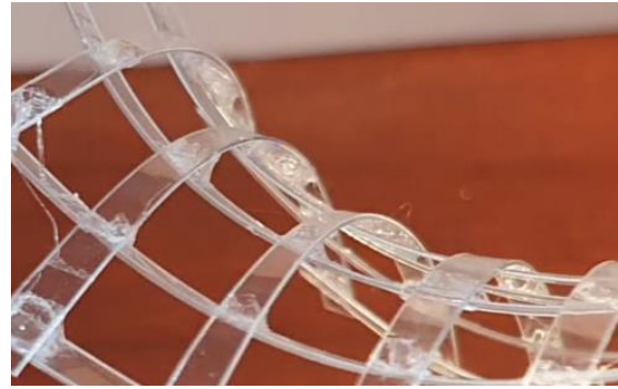
Figuur 6-83: Vervorming PMMA maquette met lossere verbindingen
