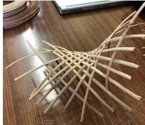
Figuur 6-12: Vervormen van een geweven raster uit pitriet tot een hyparschaal
