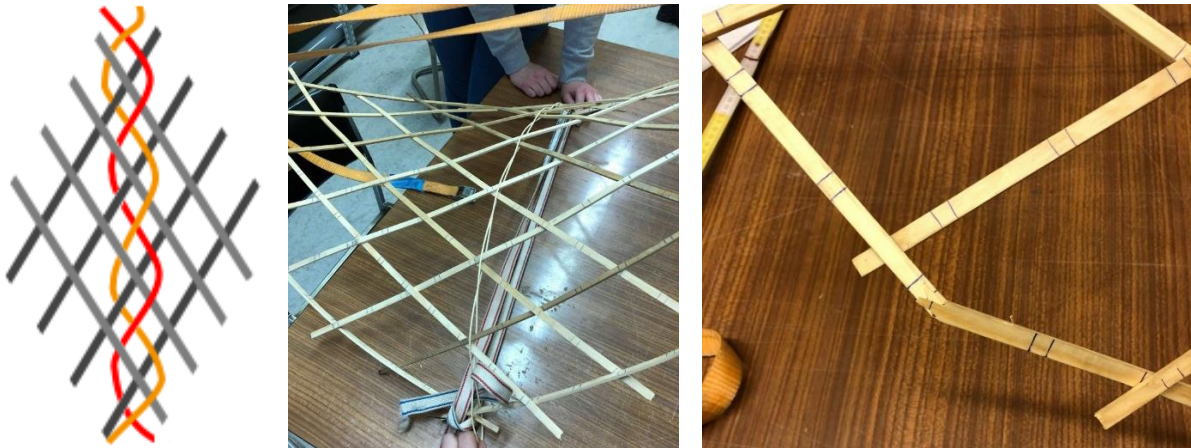
Figuur 6-18: Breuk van randlat na aanbrengen van windverband
