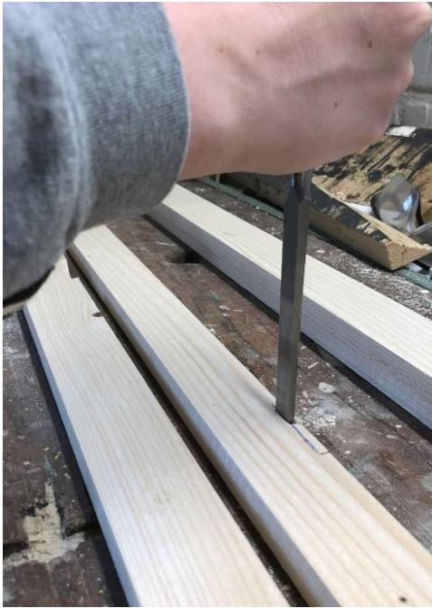
Figuur 8-30: Uitbeitelen van de sleuven
