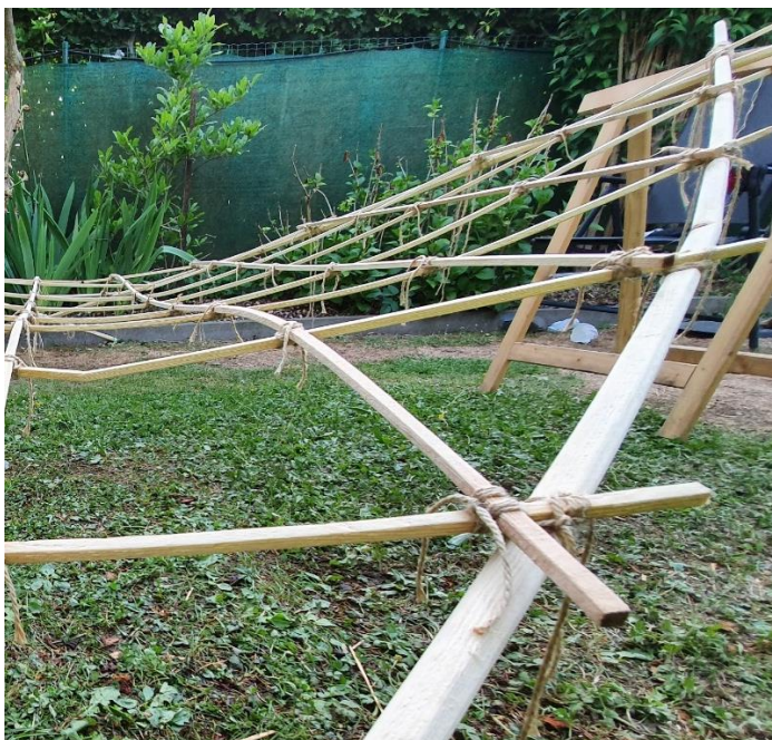
Figuur 6-58: Knik van het latwerk met rechts de gebogen randlat
