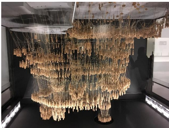
Figuur 1-1: Hangmodel Sagrada Familia, Antoni Gaudí
