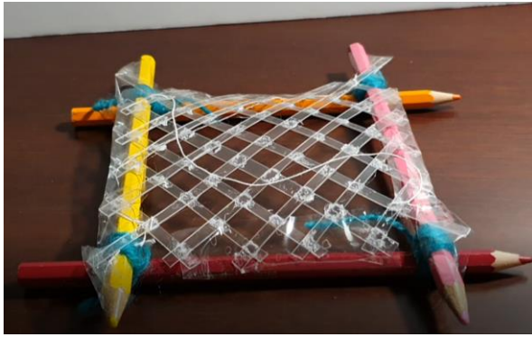
Figuur 6-85: Vervorming van PMMA maquette met ringbalk leidt tot knik
