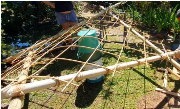
Figuur 6-75: Terugdraaien van de ringbalk leidt tot sterkere vervorming van het latwerk
