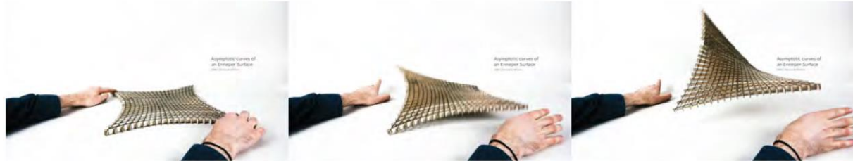
Figuur 8-15: Erectieproces asymptotische gridshell (bron: Emil Adiels)
