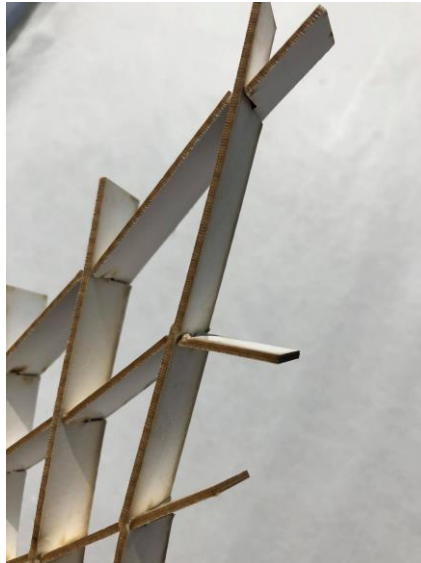
Figuur 8-18: Breuk ter hoogte van de sleuf in het karton
