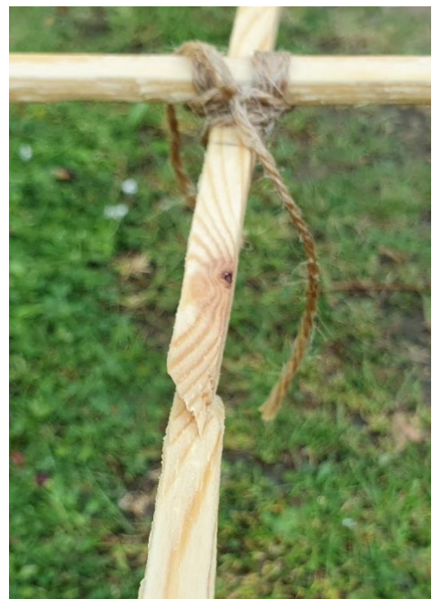
Figuur 6-59: Breuk van lat ter hoogte van een kwast
