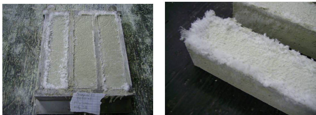
Figuur 74: Uitbloeiingen ten gevolge van de toevoeging van 25% ureum en 1/5 JBM.
