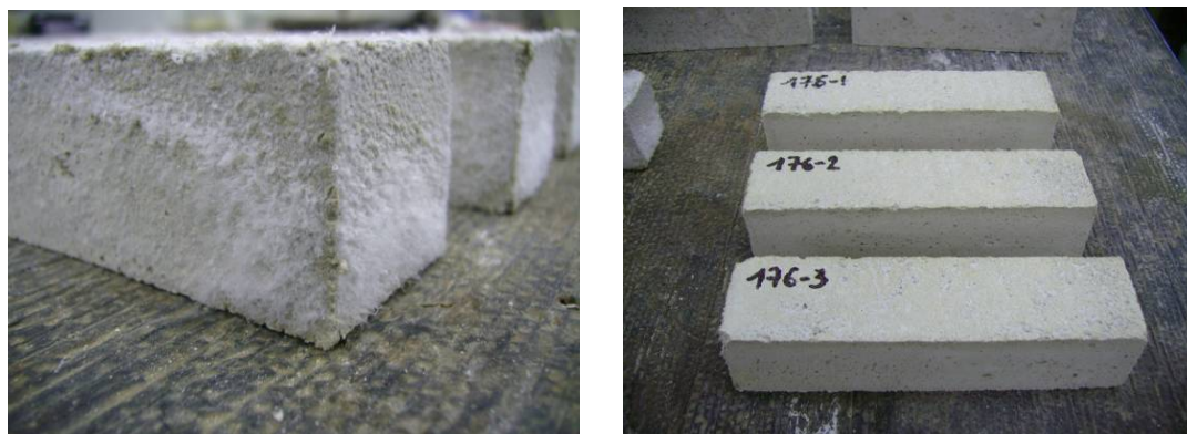
Figuur 73: Uitbloei bij 25% ureum (links) en geen uitbloei bij 1/5 JBM (rechts).
