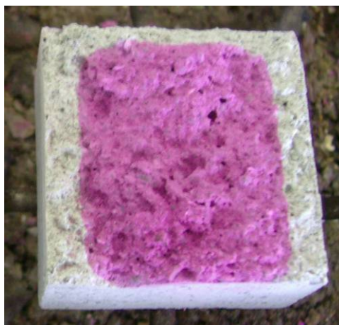
Figuur 38: Fenolftaleïne-kleuring ter bepaling van de carbonatatiediepte.
