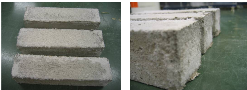
Figuur 90: Lichte uitbloei door toevoeging van 25% ureum aan Bacillus sphaericus (BS) op 20% AR 0/2.
