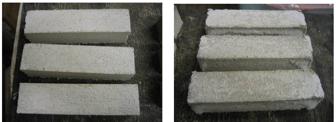
Figuur 79: Bacillus sphaericus (BS) afgecentrifugeerd zonder uitbloei (links) - Bacillus sphaericus (BS) afgecentrifugeerd. + 25% ureum met uitbloei (rechts).
