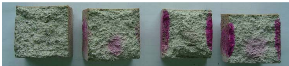
Figuur 120: Fenolftaleïne verkleuring bij toevoeging van glucose (de donkere verkleuring aan de rand is te wijten aan de contactvloeistof gebruikt voor de ultrasoonmetingen, glycerine).
