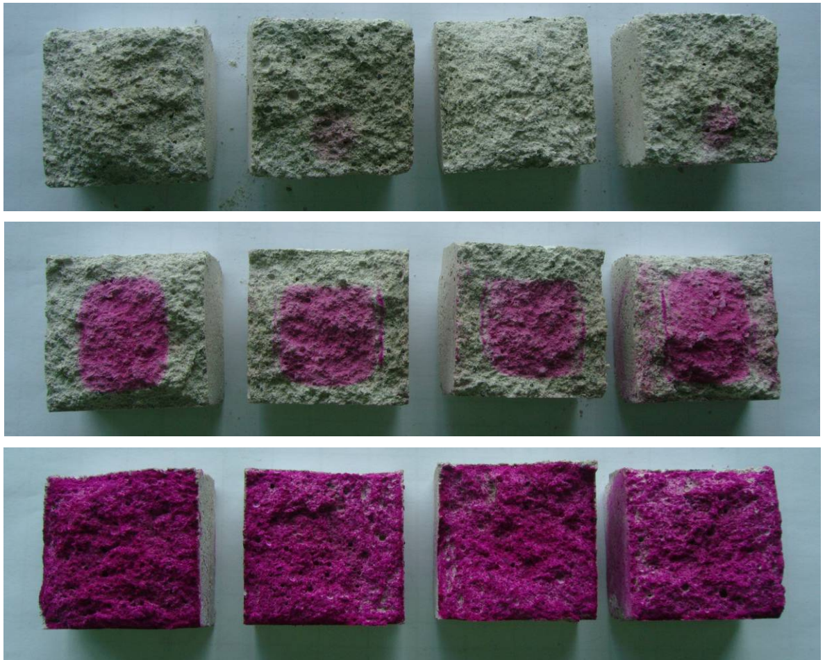
Figuur 130: Fenolftaleïne kleuring bij (\text{NH}_4)_2\text{CO}_3 (bovenaan), \text{NH}_4\text{HCO}_3 (midden) en \text{NaHCO}_3 (onderaan).
