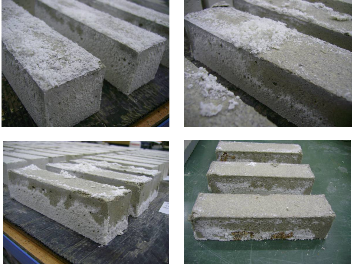
Figuur 102: Uitbloei bij de mengsels met toevoeging van van afgecentrifugeerde Bacillus alcalophilus (LMG 7120).
