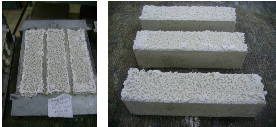
Figuur 98: Uitbloeiingen ten gevolge van de toevoeging van calcium acetaat.
