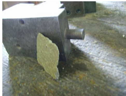
Figuur 127: Oppervlaktelaagje ten gevolge van de toevoeging van glucose.
