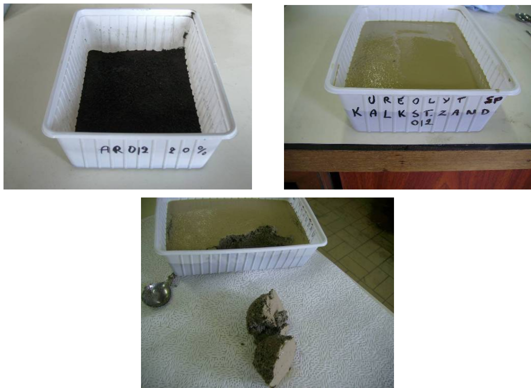
Figuur 31: Granulaten na afgieten van MO in hun medium (bovenaan) + afdeppen (onderaan).
