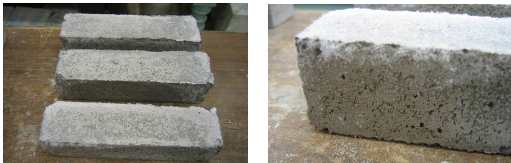
Figuur 93: Uitbloei ten gevolge van de toevoeging van ureum aan Bacillus sphaericus (BS) op 40% AR 0/2.
