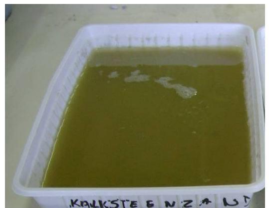
Figuur 30: 24u verzadigen van de granulaten met MO in medium.
