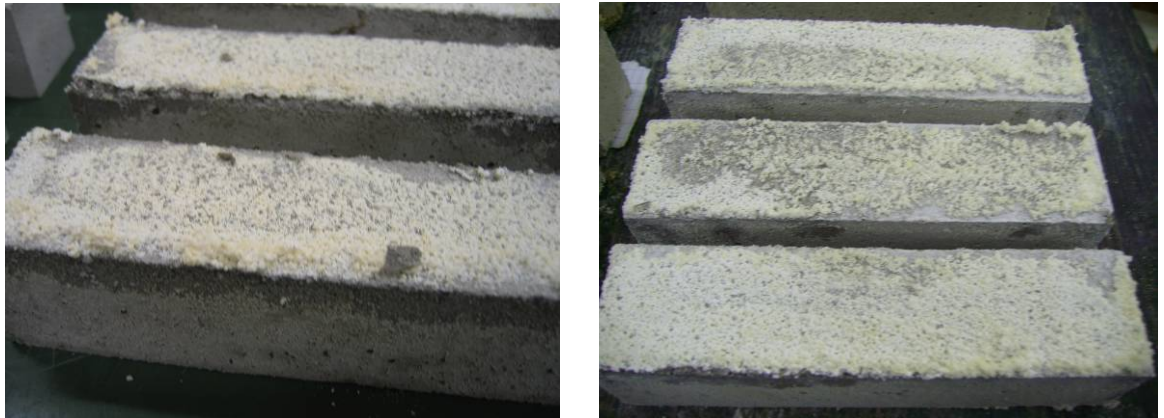
Figuur 107: Uitbloei ten gevolge van de toevoeging van calcium acetaat bij van Bacillus alcalophilus (LMG 7120) en Alkalibacillus haloalkaliphilus (LMG 17943) geïmmobiliseerd op 20% AR 0/2.
