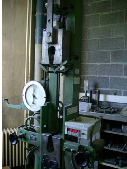
Figuur 37: Toestel waarmee de drukproeven werden uitgevoerd.
