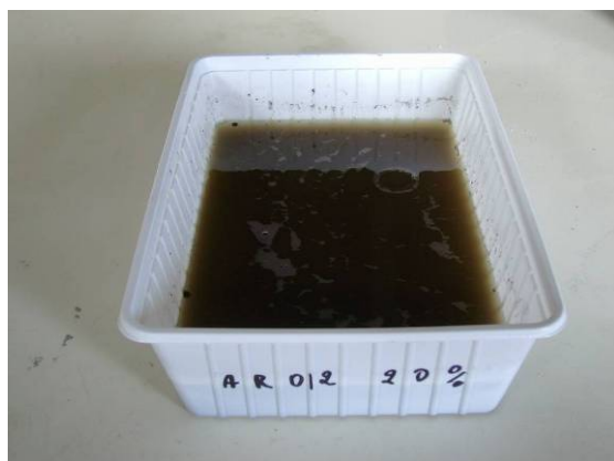
Figuur 30: 24u verzadigen van de granulaten met MO in medium.
