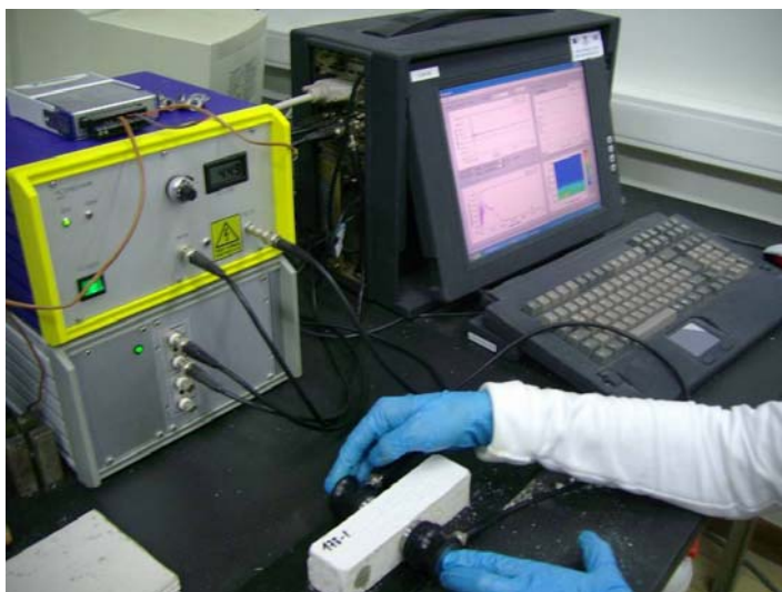
Figuur 35: Ultrasoonmetingen op het uiteinde en in het midden van het proefstuk.
