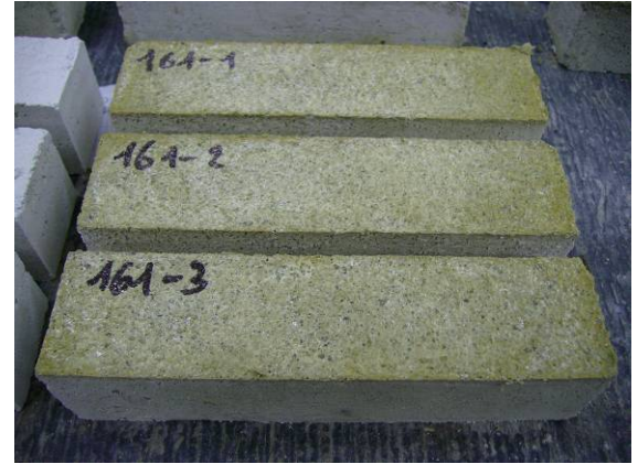
Figuur 126: Verkleuring door de toevoeging van glucose aan Gist op 20% AR 0/2 (links) en aan Gist op kalksteenzand (rechts).
