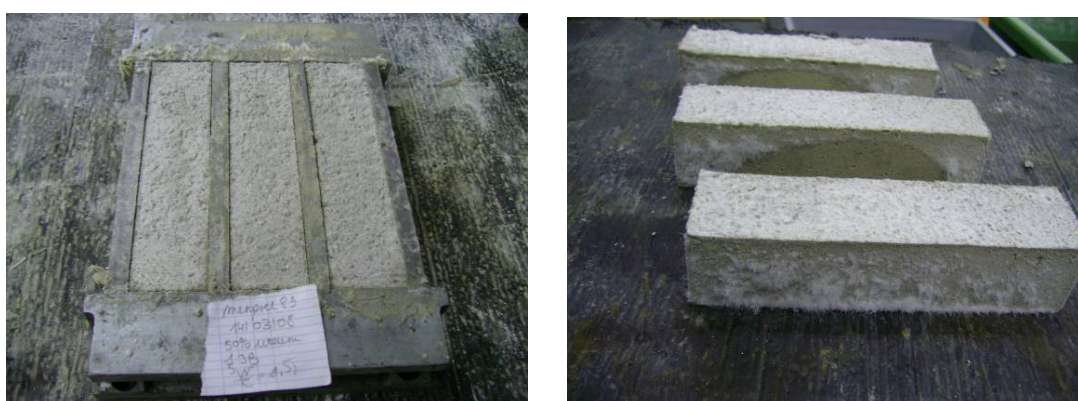
Figuur 75: Uitbloeiingen ten gevolge van de toevoeging van 50% ureum en 1/5 JBM.
