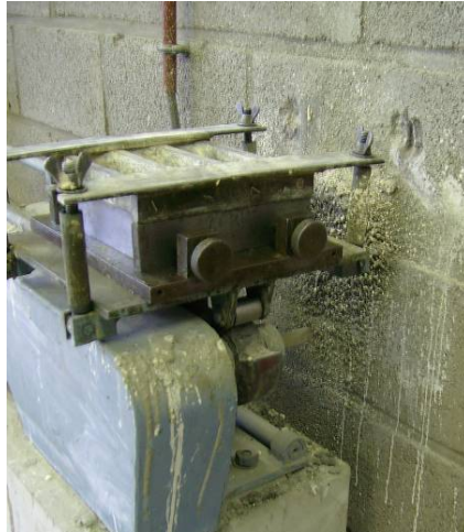
Figuur 29: Stalen mal bevestigd op een triltafel.
