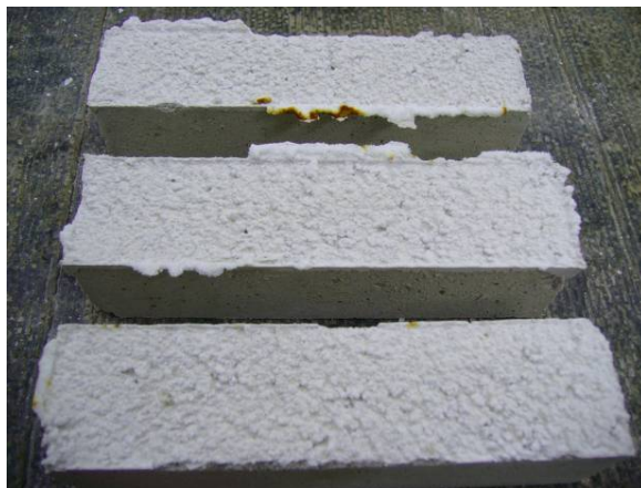
Figuur 117: Uitbloei ten gevolge van de toevoeging van calcium lactaat.
