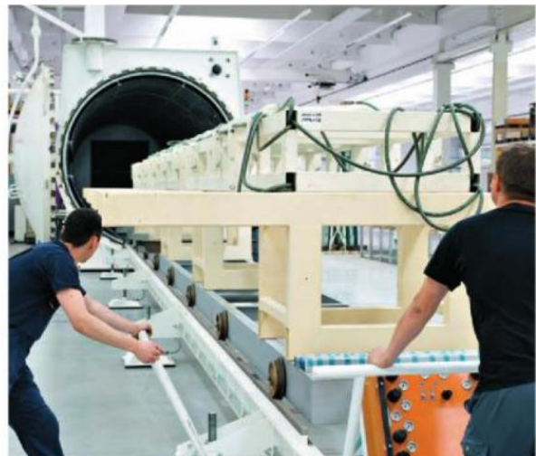
Afb. 4.30: Links: Voor het lamineren worden de glasplaten vacuümverpakt. Rechts: De speciaal ontwikkelde luchtkussenbaan waarop het glaspaneel in de autoclaaf geschoven wordt. (© Uit [3])
