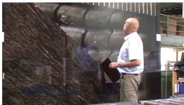
Afb. 5.4: Links: De print wordt aangebracht via een digitale printtechniek. Rechts: Alle bedrukte glaspanelen worden visueel gecontroleerd op onregelmatigheden. (© AGC Mirodan, VIDEO: AGC - De Glazen Boerderij (Glass Farm) - Artlite Digital)
