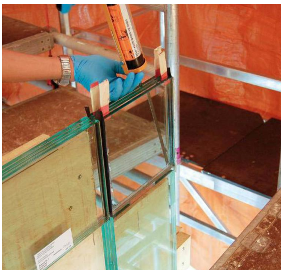
Afb. 6.24: Fabricage van de lijmverbinding. Links: Aanbrengen van lijm. Rechts: Uitharden met UV-licht. (© uit [2])
