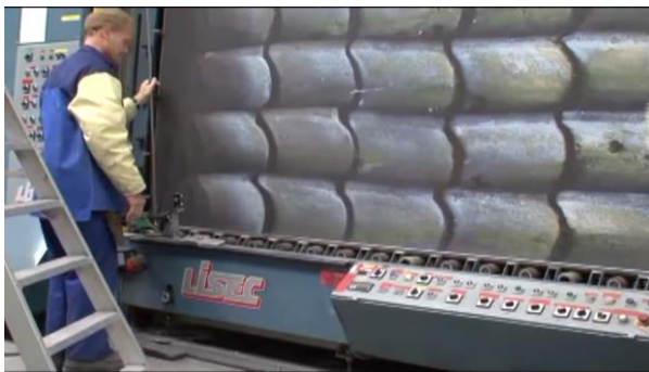
Afb. 5.13: Links: Afstandshouder aanbrengen op de bedrukte glasplaat. Rechts: De tweede glasplaat wordt gepositioneerd en bevestigd. (© AGC Westland, VIDEO: AGC - De Glazen Boerderij (Glass Farm) - Artlite Digital)
