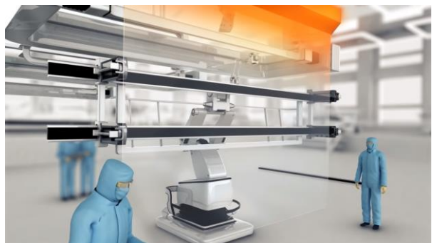
Afb. 7.2: Links: Het gesmolten glas loopt over aan beide kanten en komt terug samen onderaan. Rechts: Het dunne glaspaneel koelt af in de lucht en wordt meteen in het gewenste formaat gesneden door een robot (die je ziet staat achter het glaspaneel). (© Corning)
