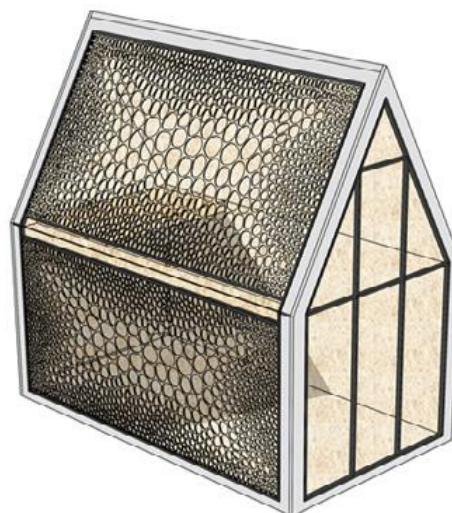
Afb. 7.11: Dungleascomposietpanelen met 3D-geprinte kern. Prototype en ontwerpvoorstel, ontwikkeld door Tim Neeskens. (© Tim Neeskens)
