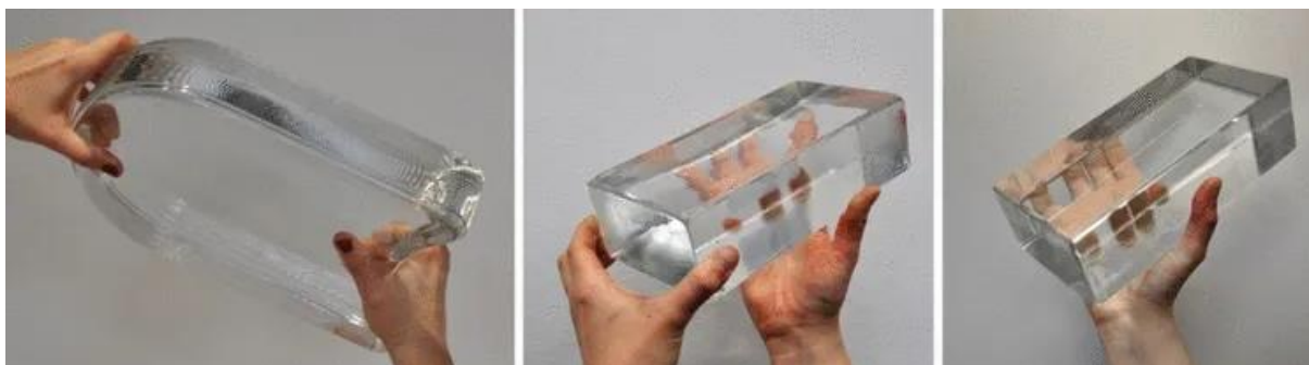
Afb. 1.24: Vergelijking van massieve glazen bakstenen. Links: Een borosilicaatglasblok gebruikt in het Atocha-monument, gemaakt met een persmal. Midden: Een natronkalkglasblok van Crystal Houses, voorafgaand aan de nabewerking. Rechts: Een natronkalkglasblok van Crystal Houses, na de machinale bewerking. (© Uit [1])
