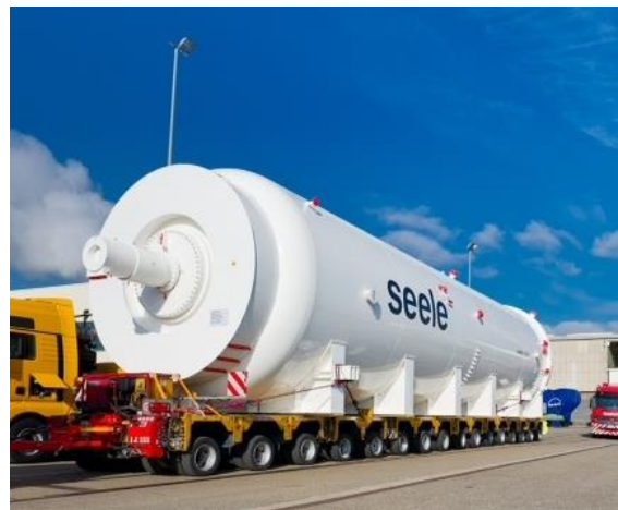
Afb. 6.13: Grote autoclaven worden de laatste jaren ingezet in de glasindustrie, met Seele als pionier. (© Uit [8])
