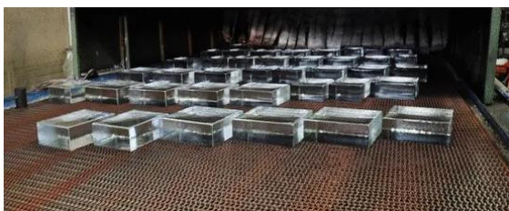
Afb. 1.6: De glasstenen komen na 36 à 38 uur uit de gloei oven. (© Uit [1])
