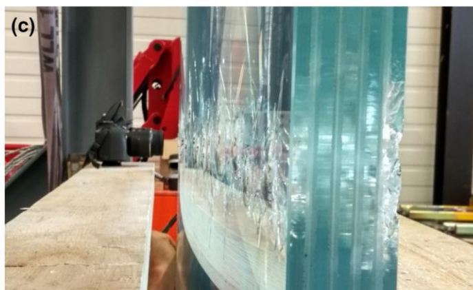
Afb. 6.38: Test op het draagvermogen van een binnenwand. A) Testopstelling met glaspanelen op ware grootte en realistische steunpunten. B) Bewust aangebrachte schade over de gehele breedte van het glas. C) Meerdere gebroken glaslagen. (© Uit [1])
