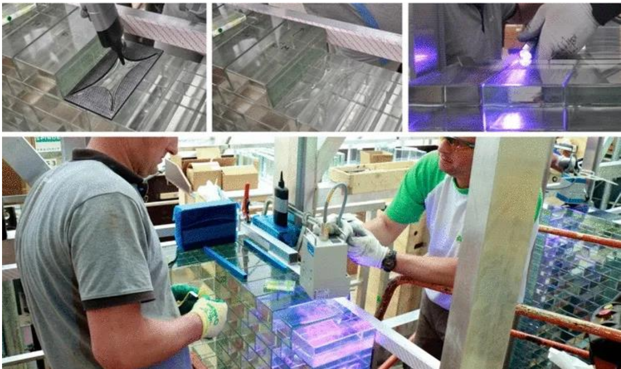
Afb. 1.8: Kloksgewijs: 1. Aanbrengen van de lijm met behulp van de X-vorm. 2. Gecontroleerde hoeveelheid lijm. 3. Lokale uitharding van de lijm door middel van UV-licht om capillaire werking te voorkomen. 4. Gebruik van een UV-lamp (intensiteit van 20 tot 60 mW/cm 2 ) voor het uitharden van de lijm gedurende 60 tot 120 seconden. (© Uit [1])
