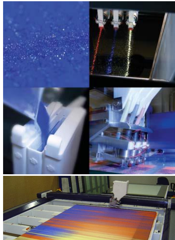
Afb. 5.27: Boven: Een speciale printkop verwerkt poeders in plaats van inkt. (© [2]) Onder: Via trillingen valt het poeder op de glasplaat. (© drupsteen.nl)
