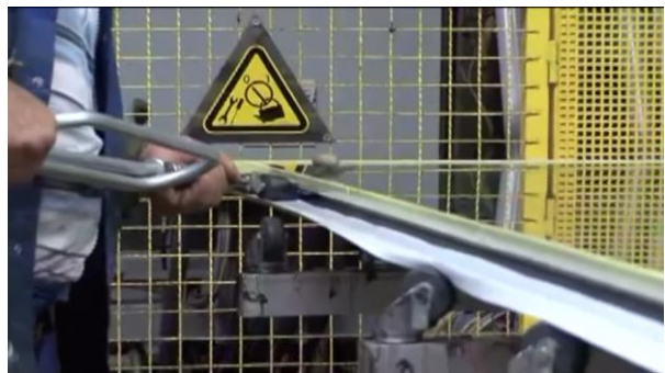
Afb. 5.14: Links: De IGU wordt handmatig gevuld met argongas. Rechts: Aanbrengen van structurele Siltal-voeg. (© AGC Westland, VIDEO: AGC - De Glazen Boerderij (Glass Farm) - Artlite Digital)
