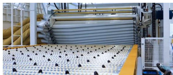
Afb. 3.16: Machine om glaspanelen warm te buigen, in combinatie met thermisch harden. (© screenshot uit 'Glaston ProBend at Glas Gasperlmaier in Austria') (niet van dit project, enkel ter illustratie)
