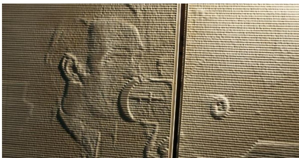
Afb. 5.26: Links: Het reliëf uitgefreesd in MDF. (© drupsteen.nl) Rechts: Het resultaat van het reliëf in het glas. (© [1])
