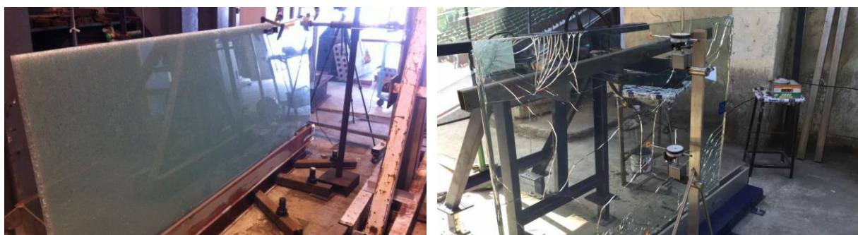
Afb. 3: Links: Test uit 2015 op gebroken thermisch gehard gelaagd glas gebonden met SentryGlas®. Rechts: Test uit 2016 op gebroken thermisch versterkt gelaagd glas gebonden met SentryGlas®. (© Kuraray)
