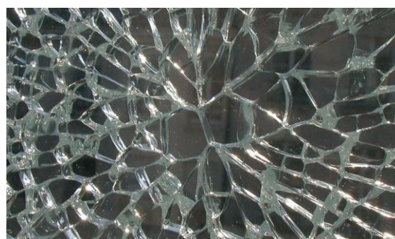
Afb. 6.22: Typisch breukpatroon van breuk door de uitzetting van een nikkelsulfidedeeltje. (© Bear Glass Blog)
