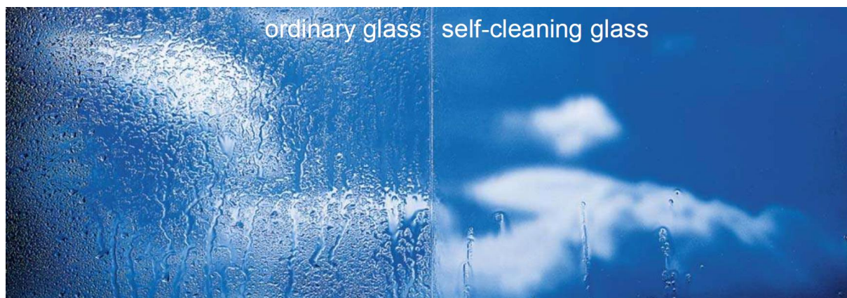
Afb. 4.2: Het verschil in transparantie na een regenbui tussen conventioneel glas en zelfreinigend glas. (© Uit [1])
