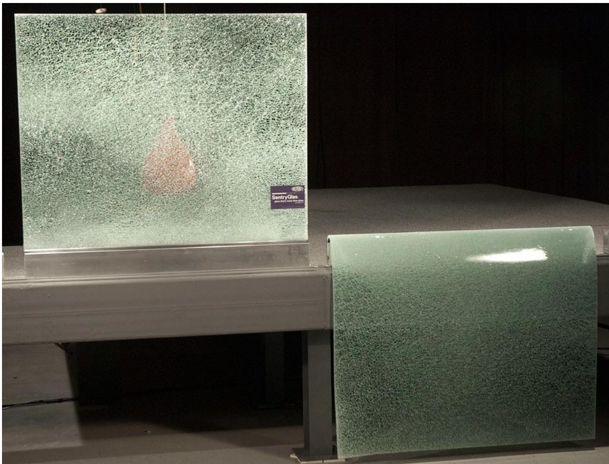
Afb. 4: Laminaten uit gehard glas. Links: SentryGlas®. Rechts: PVB. Er blijft geen enkele fysiek barrière over. (© Uit [1])
