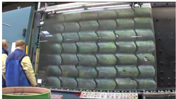
Afb. 5.13: Links: Afstandshouder aanbrengen op de bedrukte glasplaat. Rechts: De tweede glasplaat wordt gepositioneerd en bevestigd. (© AGC Westland, VIDEO: AGC - De Glazen Boerderij (Glass Farm) - Artlite Digital)
