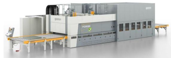
Afb. 2: Machine om vlakglas te harden. Het proces gaat van links naar rechts: de eerste machine is de oven, de tweede grote 'doos' is de ruimte waarin het glas wordt afgeschrikt. Aan deze doos zijn grote luchtkanalen en ventilatoren gekoppeld. (© Glaston)
