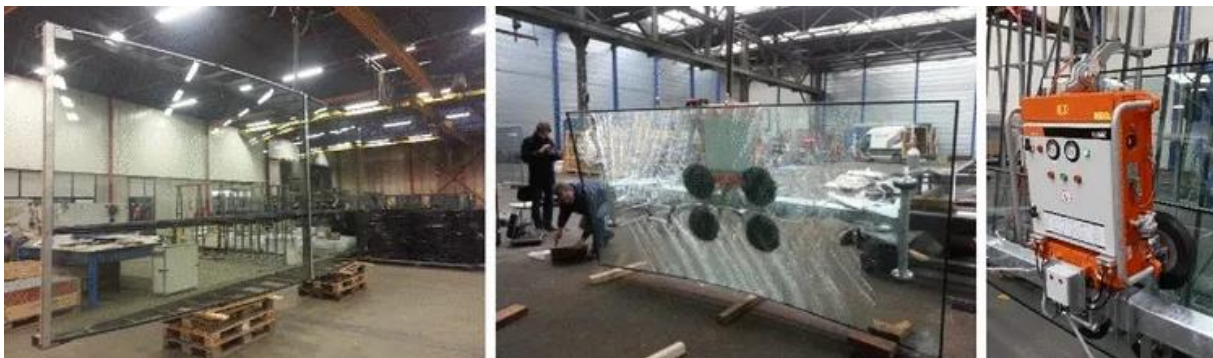
Afb. 4.17: Links: Model op ware grootte. Midden: De gebogen IGU waarvan alle vier de glasplaten zijn gebroken om het gedrag na breuk te testen. Rechts: Vacuümmachine. (© Octatube. Uit [1])
