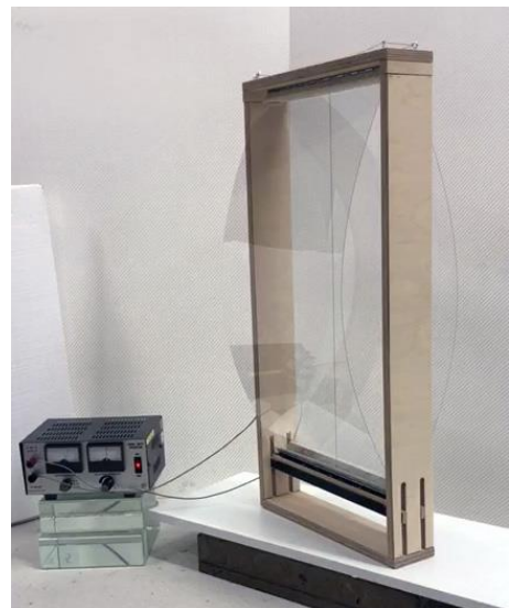
Afb. 7.10: Links: Ontwerp van een adaptieve glasgevel met dun glas, ontwikkeld door Özhan Topcu. (© Özhan Topcu). Rechts: proefopstelling van een adaptief dun glazen gevelelement dat gebruik maakt van een 'shape memory' legering om de beweging te activeren, ontwikkeld door Bahareh Miri. (© Bahareh Miri)
