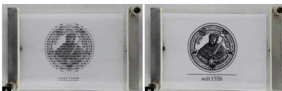
Afb. 6.5: Links: paneel zonder vloeistof (lege kanaaltjes). Rechts: paneel volledig gevuld met een vloeistof die een brekingsindex heeft die overeenkomt met die van het capillaire glas. (© [2])
