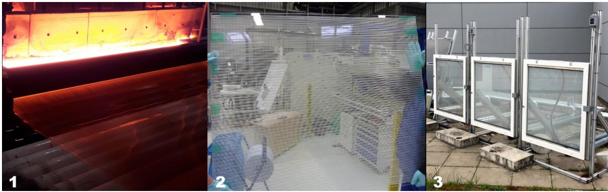
Afb. 6.4: Links: Productie van de glasplaat met normale dikte. Midden: Het laminaat. Rechts: Montage van LaWin-panelen in raamkaders. (© [4])
