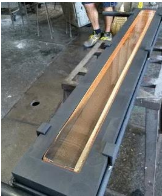
Afb. 1.13: De grafieten mallen die werden gebruikt voor de fabricage van de deur- en raamkaders. (© Uit [1])
