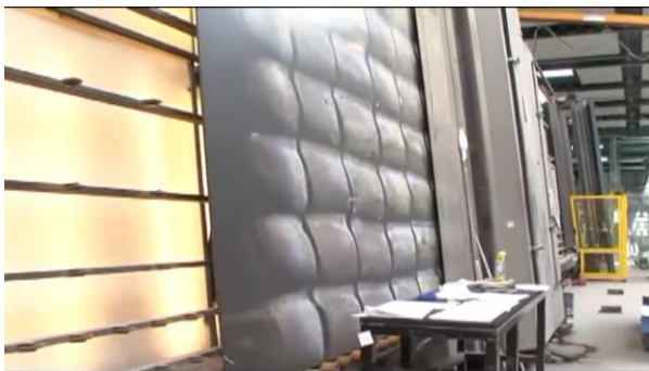
Afb. 5.12: Links: De bedrukte glasplaat wordt gewassen op de lijn. Rechts: Ook de transparante, gecoate 'tegenruit' wordt gewassen op de lijn. (© AGC Westland, VIDEO: AGC - De Glazen Boerderij (Glass Farm) - Artlite Digital)
