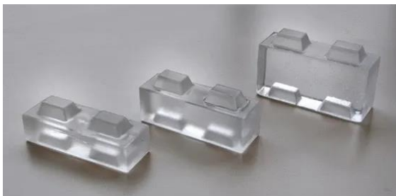
Afb. 1.16: In elkaar grijpende, droog gemonteerde glasstenen ontwikkeld door Oikonomopoulou, Bristogianni en Barou voor het project 3TU.bouw Lighthouse: Restorative Glass. (© Uit [1])
