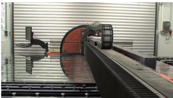
Afb. 5.4: Links: De print wordt aangebracht via een digitale printtechniek. Rechts: Alle bedrukte glaspanelen worden visueel gecontroleerd op onregelmatigheden. (© AGC Mirodan, VIDEO: AGC - De Glazen Boerderij (Glass Farm) - Artlite Digital)
