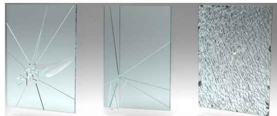
Afb. 1: Breukgedrag van glas. Links: uitgegloeid glas. Midden: thermisch versterkt glas. Rechts: gehard glas. (© saflex.com)
