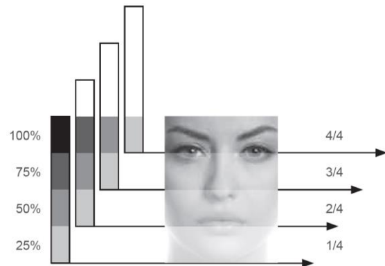
Afb. 5.6: Met Artlite Digital glas van AGC kan je verschillende niveaus van doorschijnendheid bereiken. (© [11])
