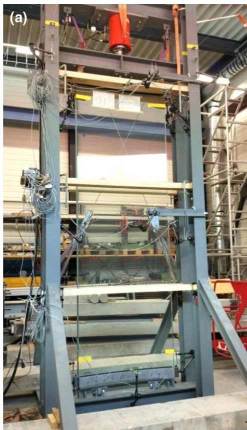
Afb. 6.38: Test op het draagvermogen van een binnenwand. A) Testopstelling met glaspanelen op ware grootte en realistische steunpunten. B) Bewust aangebrachte schade over de gehele breedte van het glas. C) Meerdere gebroken glaslagen. (© Uit [1])
