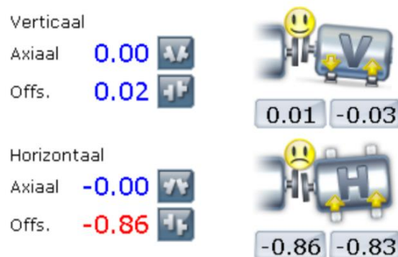
Figuur 2.4: Voorbeeld na het opmeten van de uitlijning
