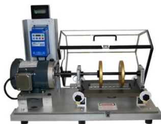
Figuur 2: De 'Machinery fault simulator'
