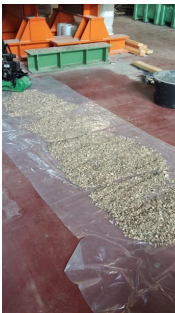
Figuur 8: Breken van de schelpen met de trilplaat
