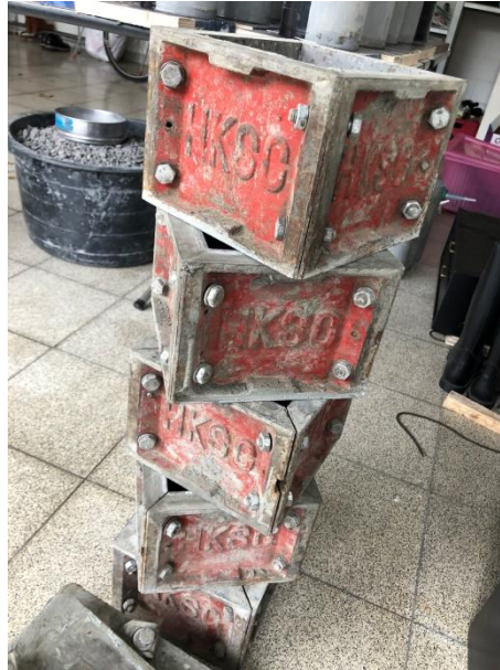
Figuur 11: De stalen mallen voor kubussen van 150 x 150 mm
