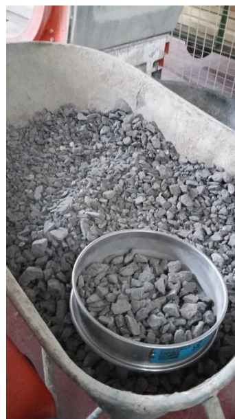
Figuur 7: Zeven van de gewassen grove granulaten
