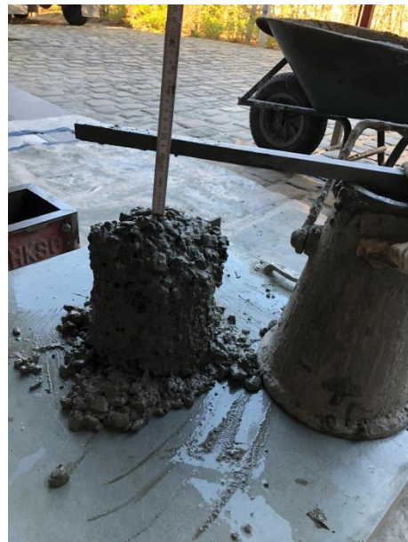
Figuur 23: Meten van de inzinking voor de bepaling van de zetmaat
