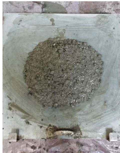
Figuur 26: Betontaart na het toedienen van 15 schokken
