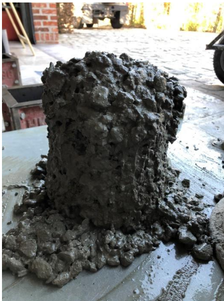
Figuur 24: Symmetrisch ingevallen betonspecie bij bepaling van de zetmaat
