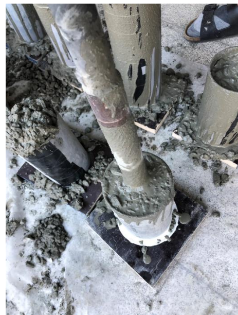
Figuur 20: Trillen van een cilindrisch proefstuk met de trilnaald
