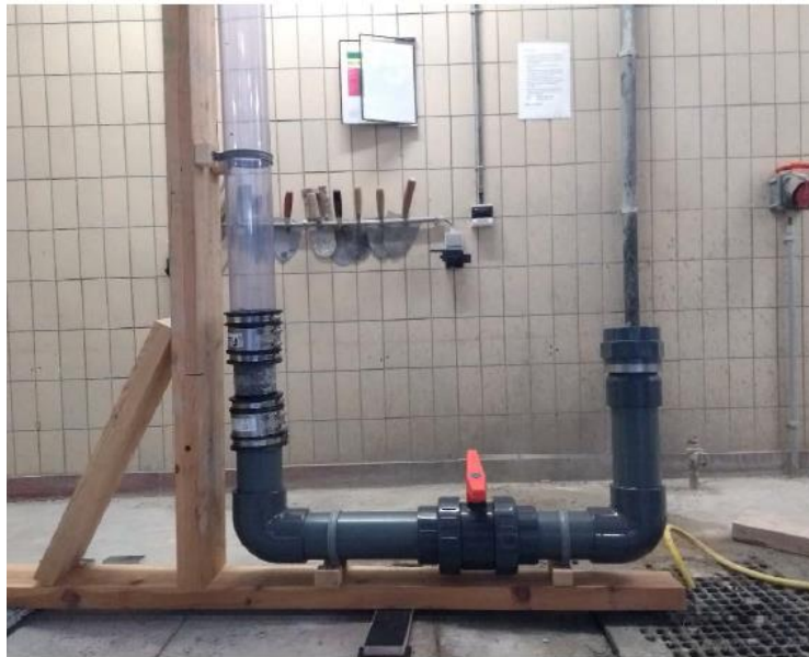
Figuur 30: Opstelling Falling Head Test van voorgaande masterproef (Decrock & Van Reybrouck, 2019)
