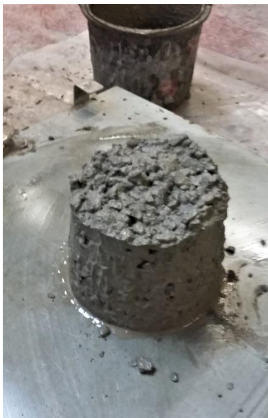
Figuur 25: Betonspecie na het verwijderen van de conus
