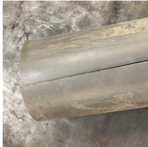
Figuur 12: Axiale naad in de pvc-mal
