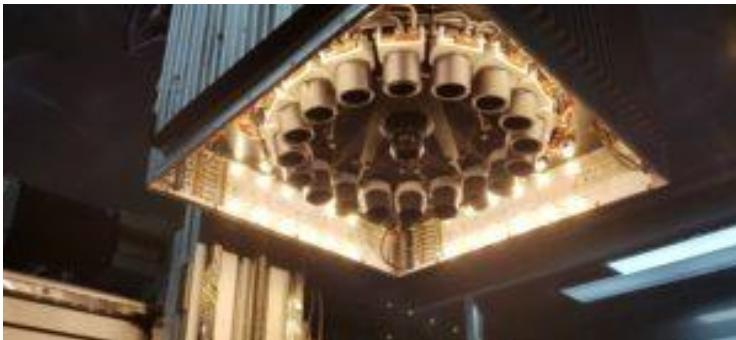
Figuur 8: Phenomate sensor en LED licht bronnen voor rood, ver-rood, wit en NIR (phenovation.com, 2020)
