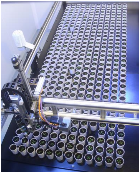
Figuur 7: WIWAM xy robotarm en positioneringstafel (wiwam.be, 2020)
