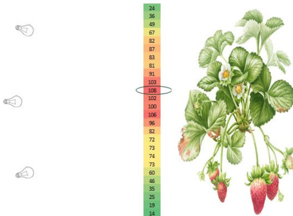
Figuur 18: Schematische voorstelling voor het toedienen van de UV-C dosis en gegeven dosissen per hoogte, tussen de waarden is een hoogteverschil van 2 cm. Dosissen worden weergegeven als J/m^2 en werden gemeten met een Opsytec RM-22 UV-meter die op 20 cm van de lampen werd opgesteld.
