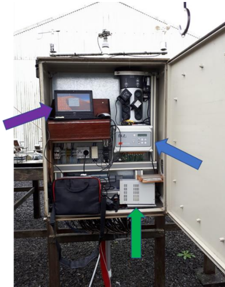
Figuur 11 De voedingspanning die de loadcellen voed (groene pijl), en die verbonden is met het datalogging-systeem (blauwe pijl), en waaraan een draagbare computer (paarse pijl) is gekoppeld
