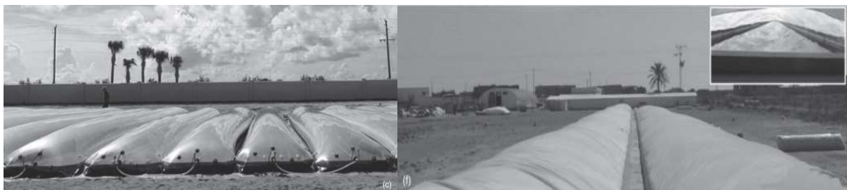
Figuur 7 Hybride fotobioreactoren. Links de opgepompte zakken, rechts overdekt bassin in tunnelvorm (Zittelli et al., 2013)
