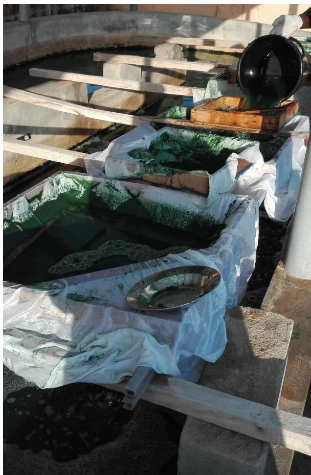
Figuur 15 Typische opstelling voor de oogst bij small-scale productie in Pahou, Benin. Een houten zeef wordt gebruikt om de contaminatie uit de cultuur te zeven. Waarna de cultuur over 2 opvolgende (witte) filterdoeken wordt gebracht.
