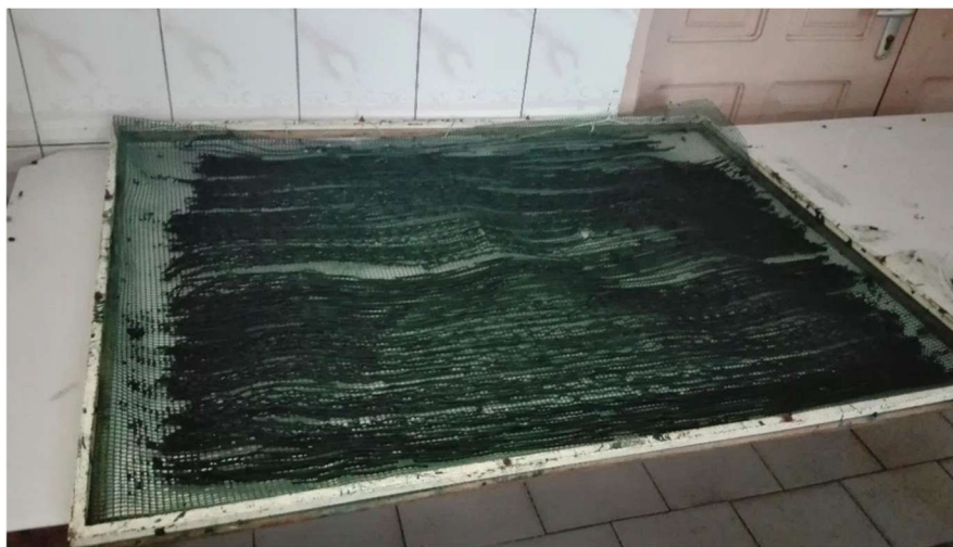
Figuur 16 Staafvormige spaghetti-strengen van spirulina op een geperforeerde plaat, klaar voor het droogproces.
