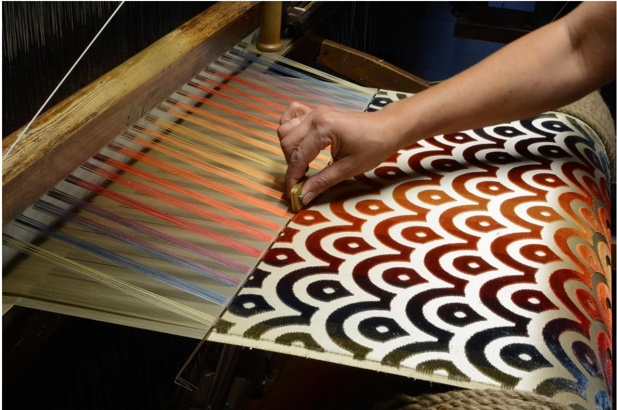
Afbeelding 12: Fondazione Arte della Seta Lision Firenze, doorsnijden van de lussen op een handroedengetouw
