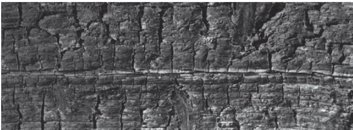
Figuur 7: Zachtrot in hout afkomstig van een koeltoren (Schmidt, 2006)
