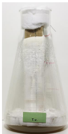
Figuur 17: Pile-test uitgevoerd met Trametes versicolor , duidelijke grens van schimmelgroei aan de oppervlakte vanaf een bepaald niveau (Meyer & Brischke, 2015)
