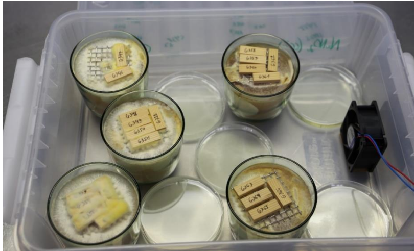
Figuur 51: Variatie in schimmelgroei bij proefopstelling met \text{NaNO}_2 (66% RH) voor grenen
