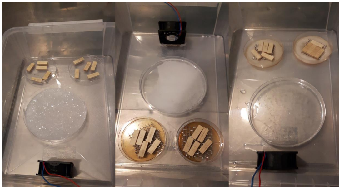
Figuur 22: Proefopstelling miniblocktest, links: zonder agar, midden: op agar, rechts: agar en Trametes versicolor
