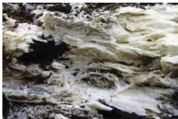
Figuur 12: Witrot in hout veroorzaakt door Phanerocheate chrysosporium (de Mattos-Shipley, et al., 2016)
