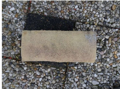
Fig. 6: Links de mousse voor de inblaasopeningen, rechts de mousse voor de extractieopeningen
