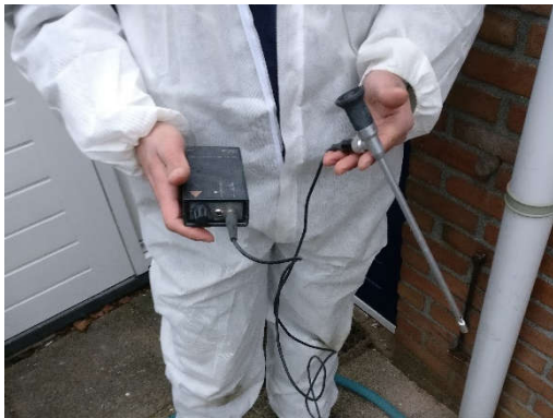
Fig. 9: Links een endoscoop, rechts het beeld in de spouwmuur verkregen via de endoscoop
