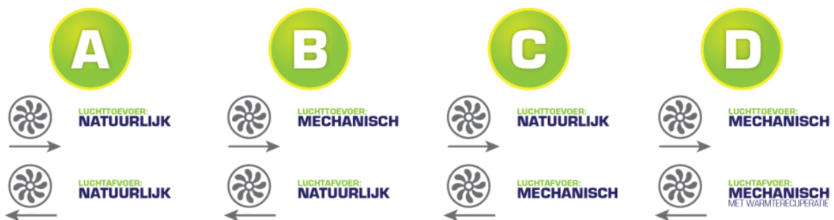
Figuur 1: De verschillende ventilatiesystemen (Ventilatiesysteem, 2013)
