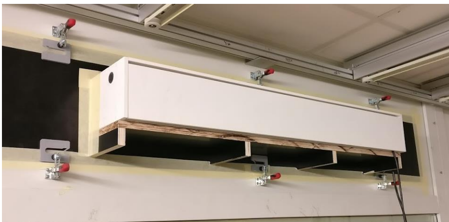
Figuur 25: Provent D-luxe geïnstalleerd in de testopening met afgeplakte spleten
