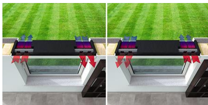
Figuur 12: Voorstelling alternerende werking Endura Twist (Endura Twist, z.j.)
