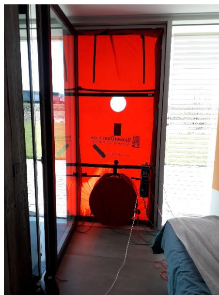
Figuur 72: meetopstelling W4 - BD
