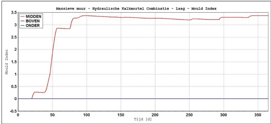
Figuur 10.47-A| Massieve muur – Hydraulische Kalkmortel Comb.- Mould Index
