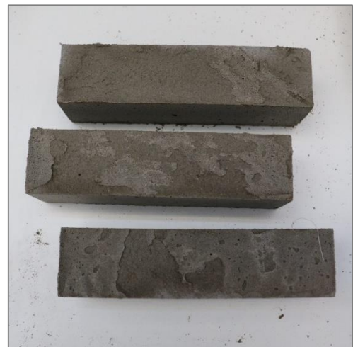
Figuur 10.3| Ontkiste proefstukken cementmortel
