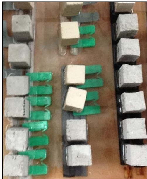
Figuur 10.5| Detail: horizontale stabiliteit proefstukken
