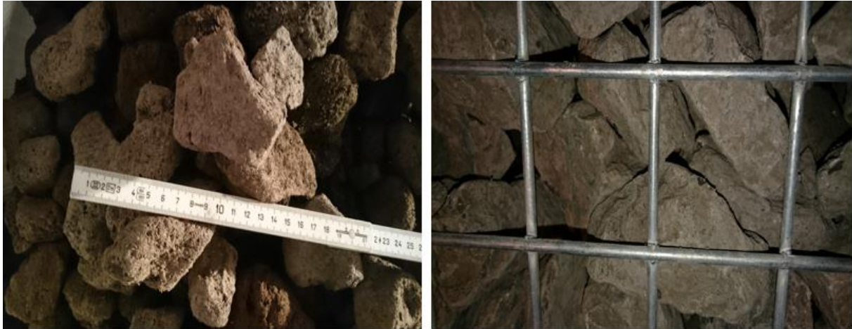
Figuur 5. Soort stenen: lavastenen (links) en keien (rechts).
