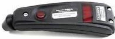
Figuur 9: Infraroodthermometer (Exergen 501)
