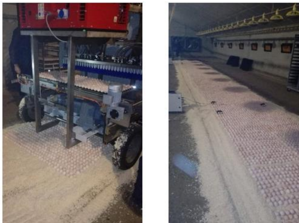
Figuur 14: Links: Nestborn-machine die eieren op het strooiselbed legt; Rechts: Het strooiselbed met loggers om temperatuur op te volgen
