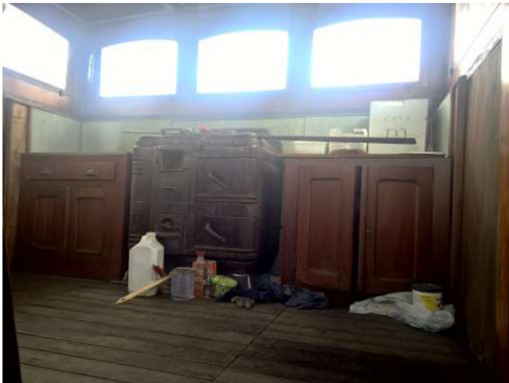
Afb. 30 De achterzijde van de ruime stuurhut van de 'Alyv' (1938, Baasrode), gezien vanuit de roef aan de den. Links een kast met wastafel, midden het kolenfornuis.
