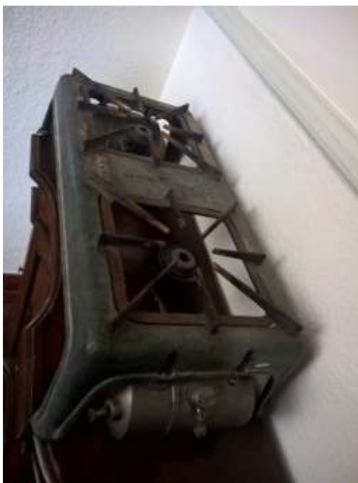
Afb. 59 Een draagbaar dubbelbekken op carbuur. Collectie Scheepvaartmuseum Baasrode VZW.
