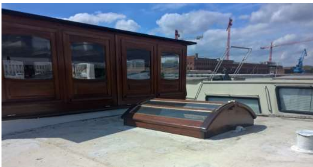
Afb. 51 Een lichtkoepel op de salonroef van de 'Dover'.
