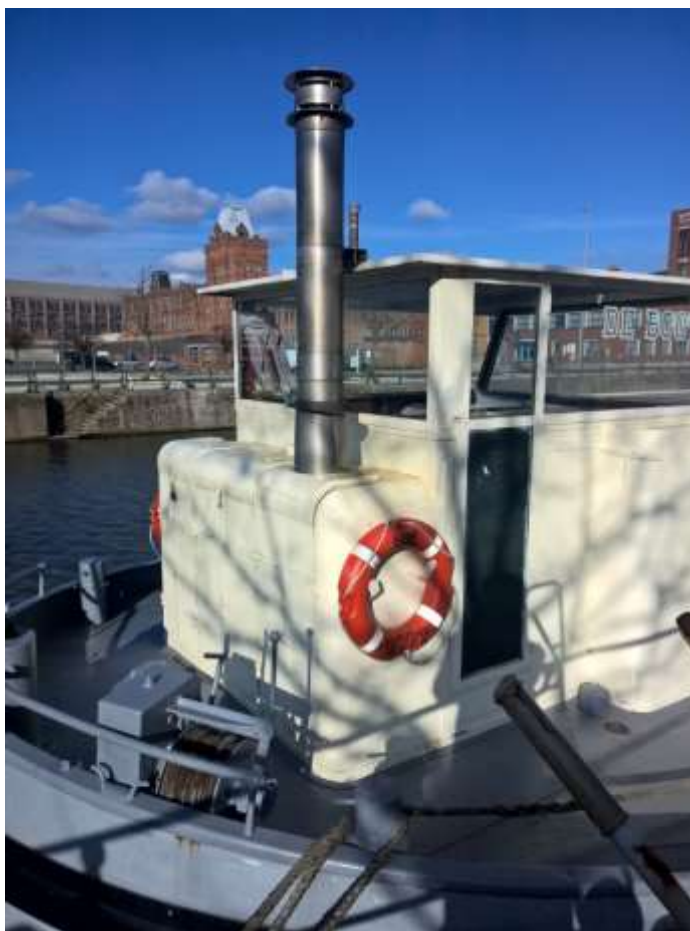
Afb. 60 De tabernakels op de SARMA spits 'De Boot'. De schoorsteen is een toevoeging, en ook de rest van het schip is sterk verbouwd.
