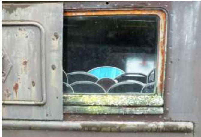
Afb. 39 Raam van de roef aan de den van de 'Alyv' (1938, Baasrode), met voorzetraampje en stormluik.
