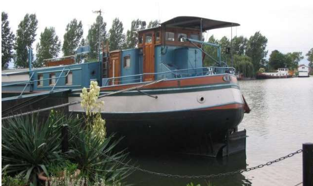
Afb. 4 SARMA spits 'Klafer' (1942, werf De Wachter, Boom). Bemerkt de ietwat spitse kont, de uiterst kleine stuurhut en de getrapte roef.
