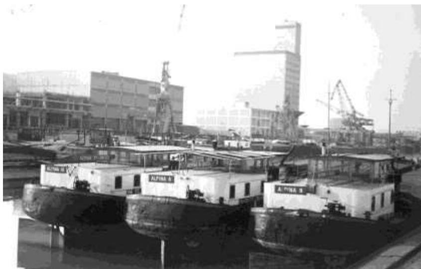
Afb. 6 TAMSA spitsen. Bemerkt de hoge, vierkante roef en het geveegde achterschip.
