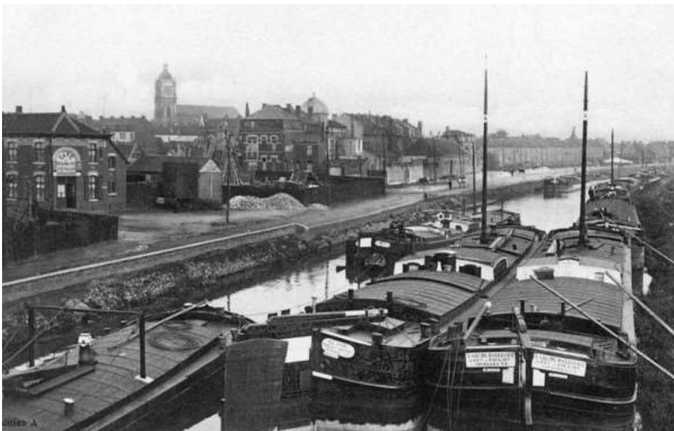
Afb. 9 Twee houten walen naast elkaar. Bemerkt het grote opgeklapte roer, de mast en de woning in het midden van de luikenkap.
