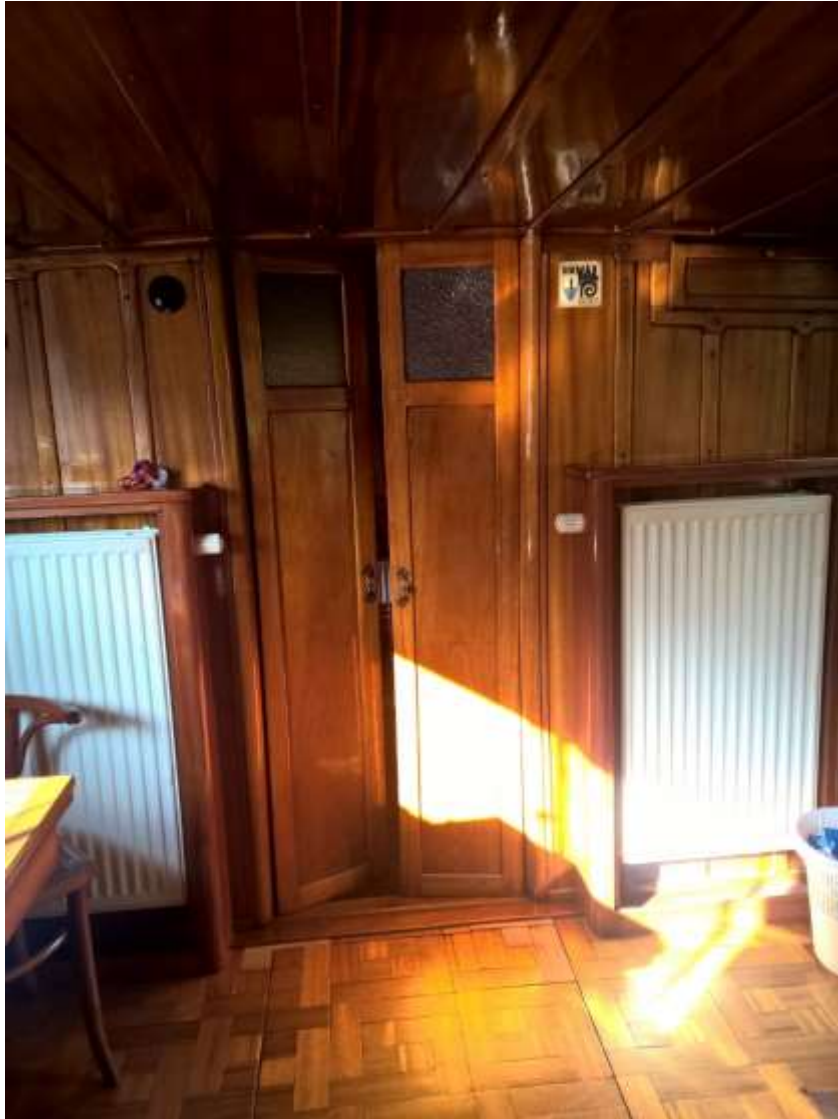
Afb. 44 Zicht naar voren op de deurtjes van de roef van de 'Rejean'. Bemerkt het bergluikje rechtsboven. De radiatoren zijn vanzelfsprekend een latere toevoeging.
