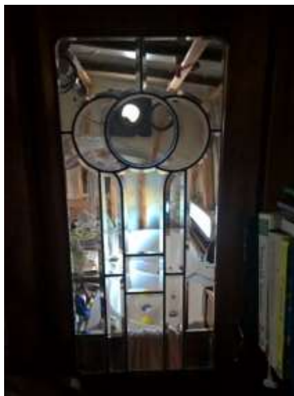
Afb. 41 Glas in koperraam in de slaapkooideur van de 'Loam' (1938, Boom) aan stuurboordzijde.
