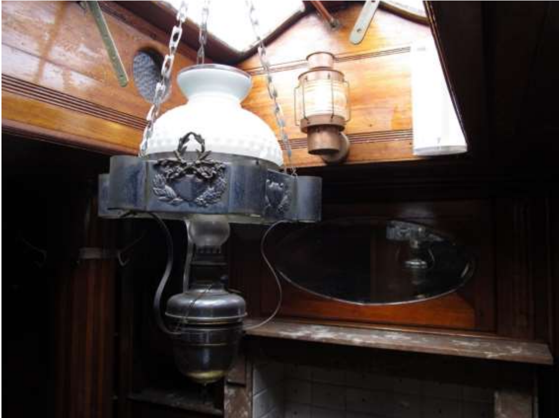
Afb. 53 Een petroleumlamp opgehangen in de claire-voie van de 'Lauranda'. Erachter zijn elektrische lichten.
