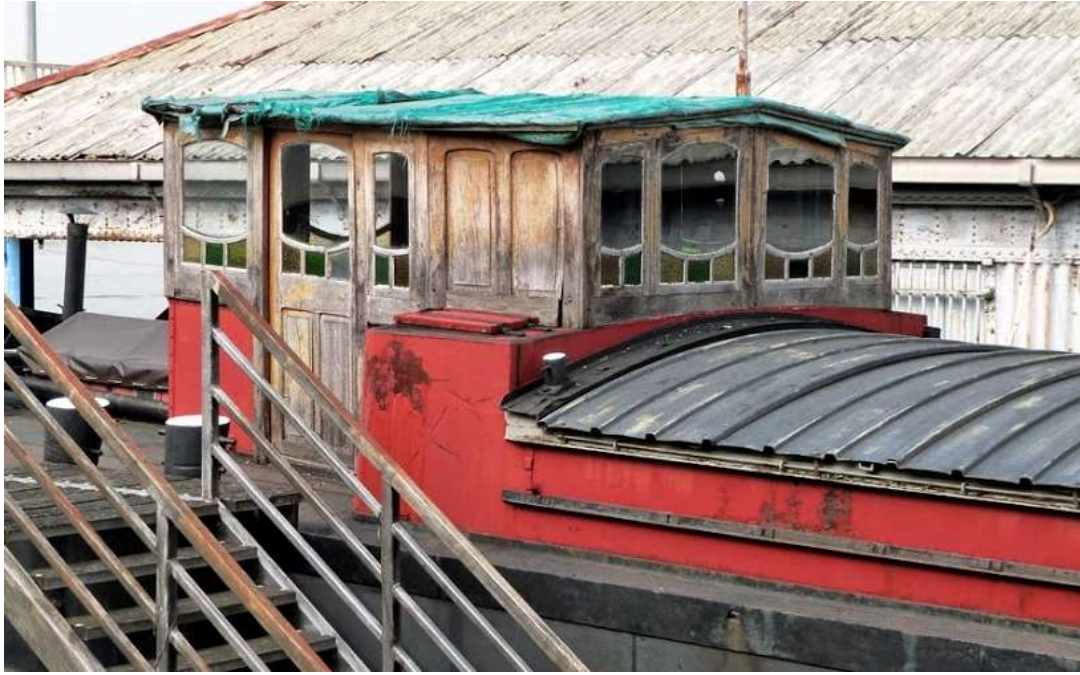
Afb. 33 De stuurhut van de 'Lauranda' (1928, Baasrode) met de typisch gevormde vensters met gekleurd structuurglas.
