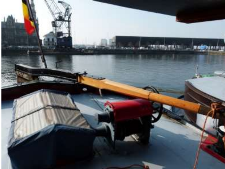
Afb. 24 Zicht op het achterdek van de 'Mon Désir' (1913, Merelbeke) van onder de open stuurhut. Links de afgedekte claire-voie, rechts de ankerlier onder het inspet.
