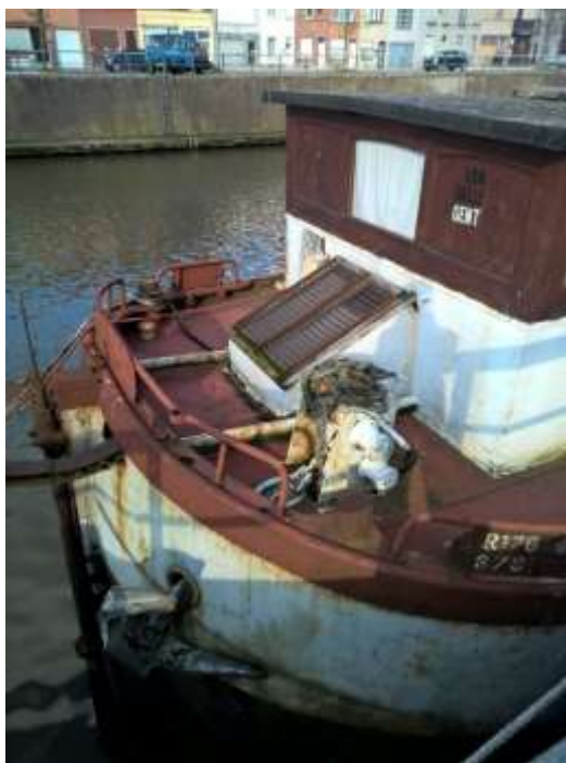
Afb. 50 De koekoek op het achterschip van de 'Hubert' slechts verworden tot lichtschacht. Langsij de kettingen ter bediening van het roer.
