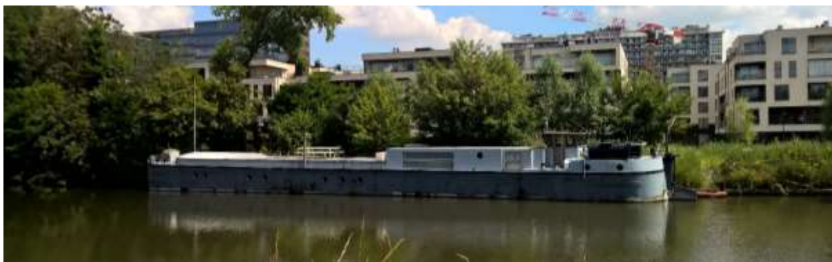
Afb. 5 Strasbourgspits 'Ship-ping', gezien vanaf de Stropkaai in Gent. Bemerkt het ontbreken van zeeg en het opgeboeide achterdek met de ronde patrijspoortjes.
