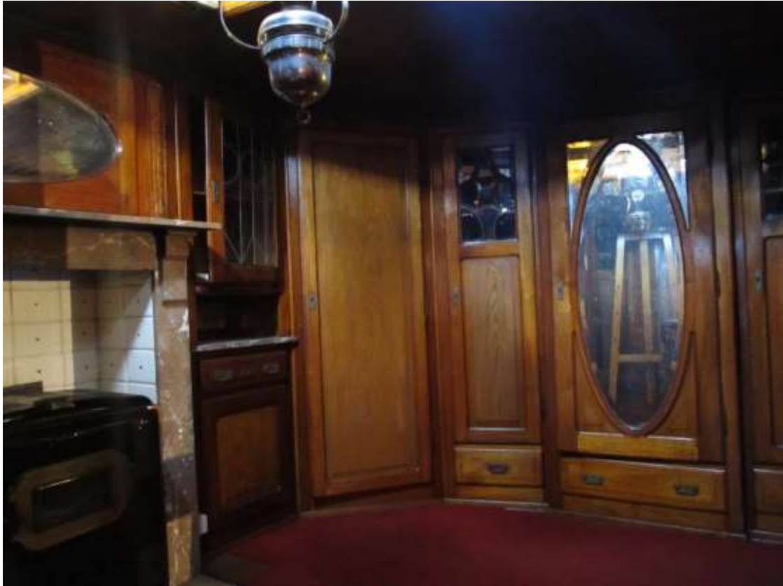
Afb. 22 De bakboordzijde van het achteronder van de 'Lauranda' (1928, Baasrode). Bemerkt de kromming van de kastenwand, die meeloopt met het ronde achterschip. Links de kachel in een roodmarmere schouw met schroeftegels.
