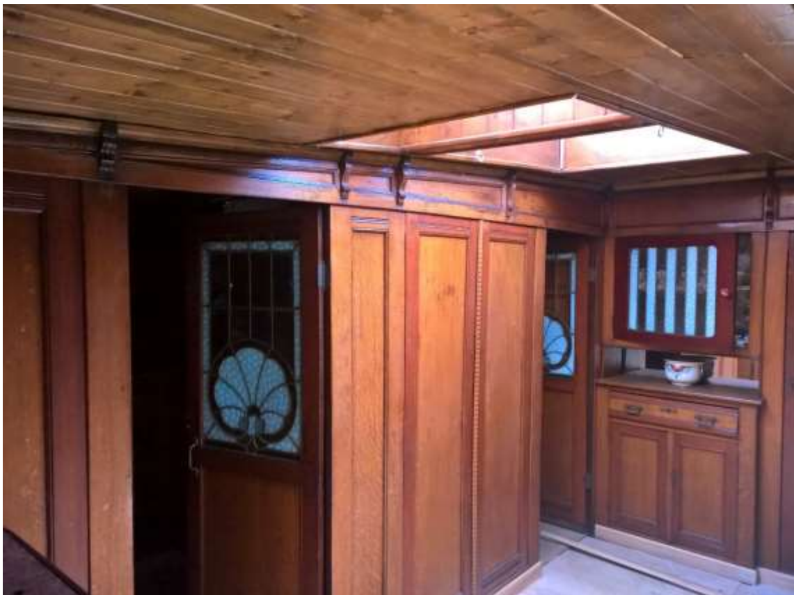
Afb. 23 Het achteronder van de 'Mon Désir' (1913, Merelbeke) met aan stuurboordzijde de deurtjes naar de slaapkooien. Bemerkt de claire-voie en de oplopende daklijn, die de kromming van het achterdek volgt.
