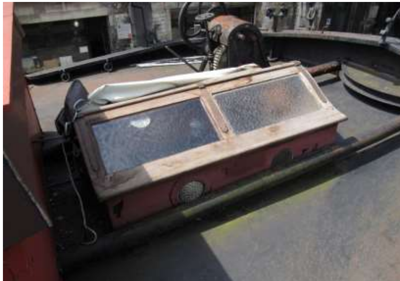
Afb. 25 De claire-voie op het achterdek van de 'Lauranda' (1928, Baasrode). Erlangs lopen de kettingkokers van de stuurhut naar het roerkwadant.
