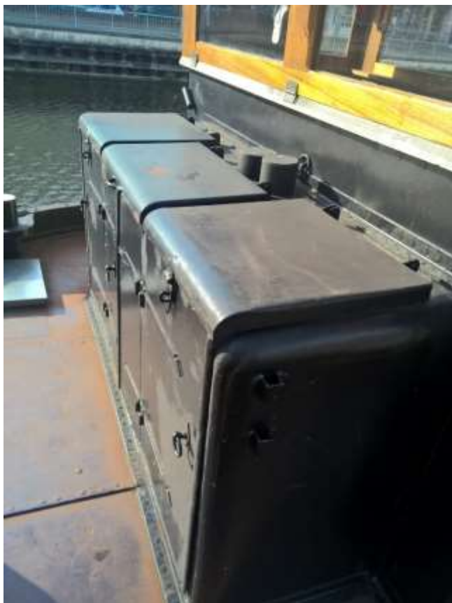
Afb. 62 Tabernakels op de SARMA spits 'Rejean'. Bemerkt de schoorstenen boven de middelste kast, en de bevestigingspunten voor de markies aan de zijde.
