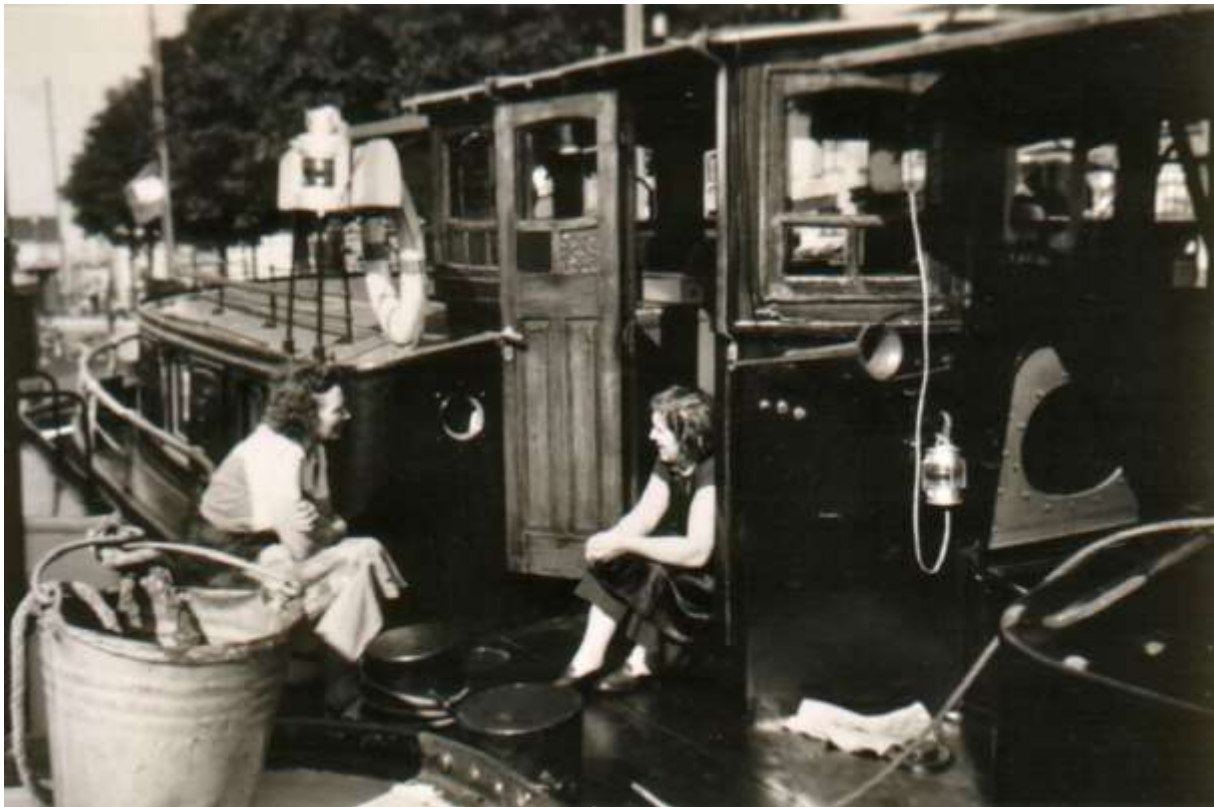
Afb. 34 Stuurhut met karakteristieke structuurglasvensters en salonroef op de 'Essex' aan de Gentse Muide in 1929.
