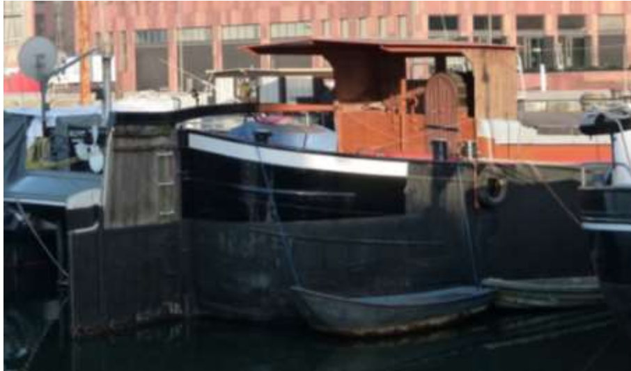
Afb. 17 De halfopen stuurcabine van de 'Mon Désir' (1913) bij het Antwerpse MAS, met de toegangskoekoek zichtbaar.
