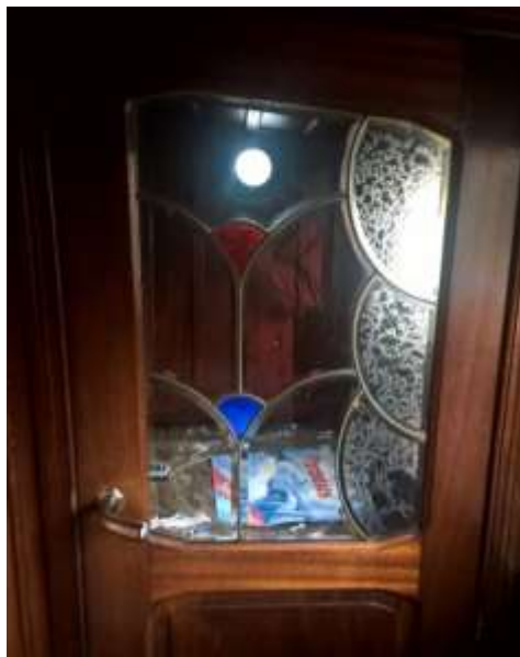
Afb. 40 Glas in koperraam in de slaapkooideur van de 'Alyv' (1938, Baasrode) aan stuurboordzijde. Bemerkt de opvallend gevormde klink en de lichtrand in de wand van de alkoof.
