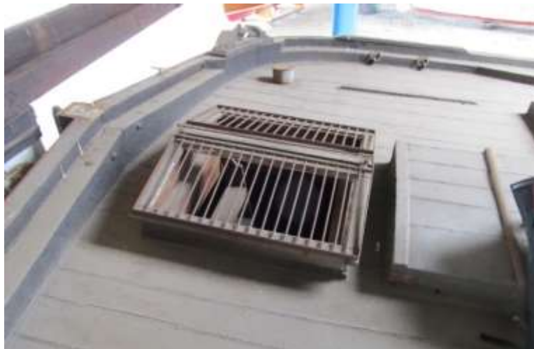
Afb. 49 De betraliede koekoek op het achterschip van de houten waal Céphée (1937) die fungeerde als toegang en als venster. Niet zonder gevaar overigens, want tijdens de vaart zwaaide het helmhout over de opening. De Fransen noemden het de 'guillotine'. Bemerkt de schoorsteen op er achtergrond.
