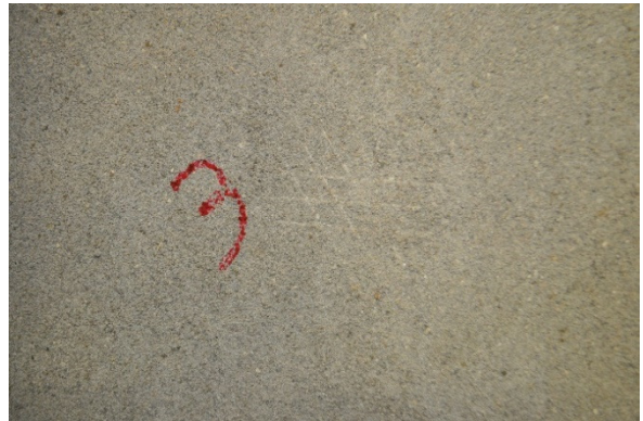
Figuur 67: Visueel resultaat van de krasproef
