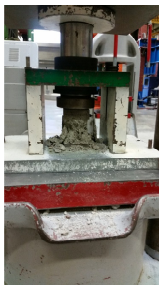
Figuur 72: Proefopstelling na breuk
