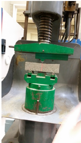
Figuur 75: Proefopstelling voor breuk
