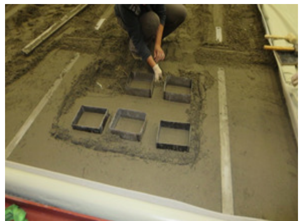
Figuur 29: Aanmaken proefplaatjes uit proefvloer
