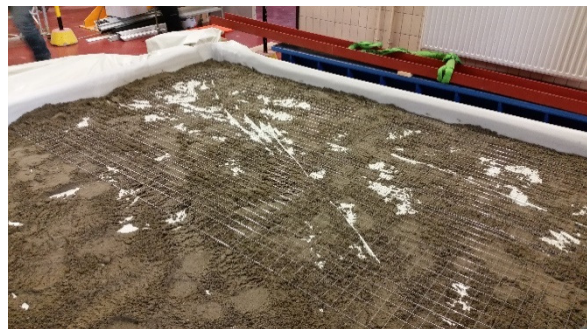
Figuur 18: Wapeningsnet 50 mm x 50 mm x 2 mm
