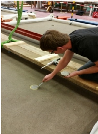
Figuur 59: Verlijmen van een pastille
