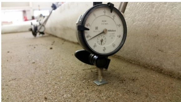
Figuur 34: Analoge meetklok aan de rand van de proefvloer
