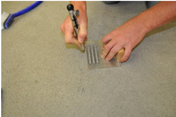
Figuur 66: Uitvoeren van de krasproef
