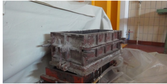
Figuur 26: Balkvormige metalen bekisting
