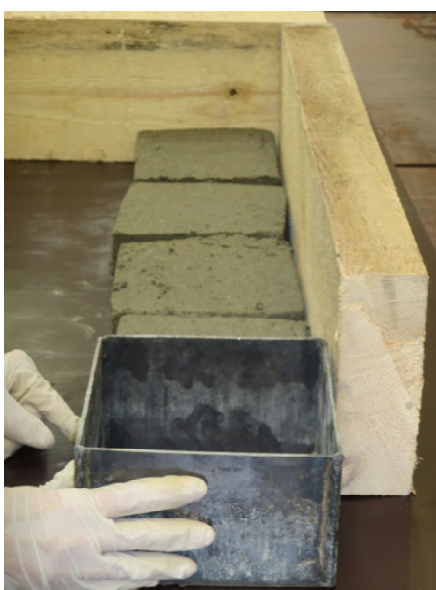
Figuur 30: Ontkisten proefplaatje om later proefstukken uit te zagen
