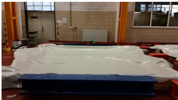
Figuur 17: Onderliggende PVC-folie
