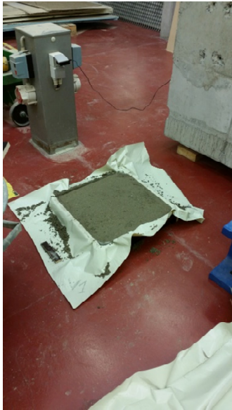
Figuur 25: Plaat aangebracht in houten bekisting
