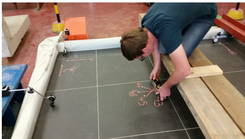
Figuur 43: Opmeten van meetpunten met behulp van het Demec-toestel
