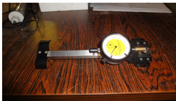
Figuur 33: Afleesschaal Demec-toestel
