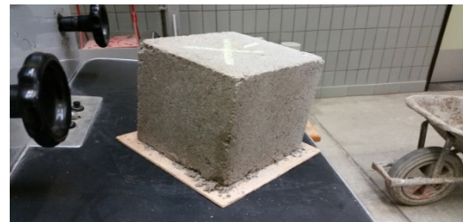
Figuur 27: Kubusvormig proefstuk
