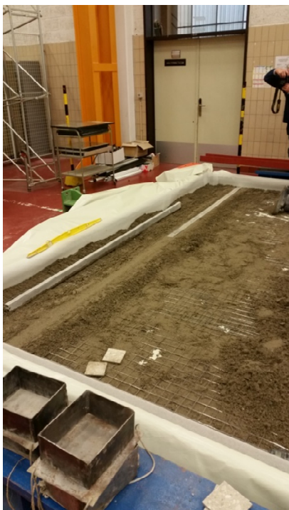
Figuur 19: Plaatsing referentielatten voor bepaling niveau
