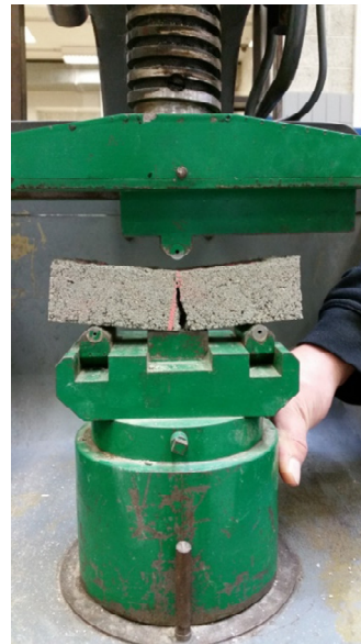
Figuur 76: Proefopstelling na breuk
