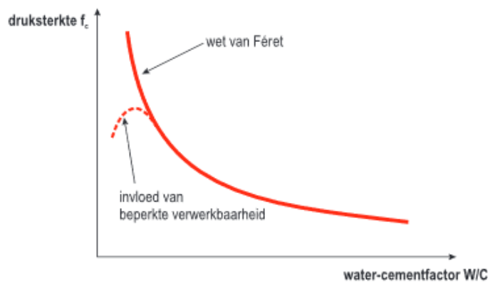
Figuur 9: Druksterkte in functie van de W/C-factor [10]
