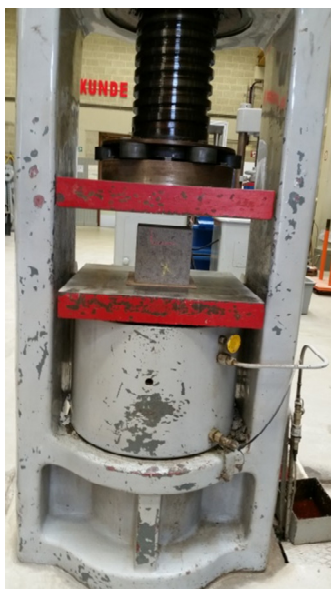
Figuur 71: Proefopstelling voor breuk
