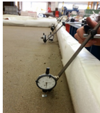
Figuur 35: Bevestiging meetklokken aan metalen liggers
