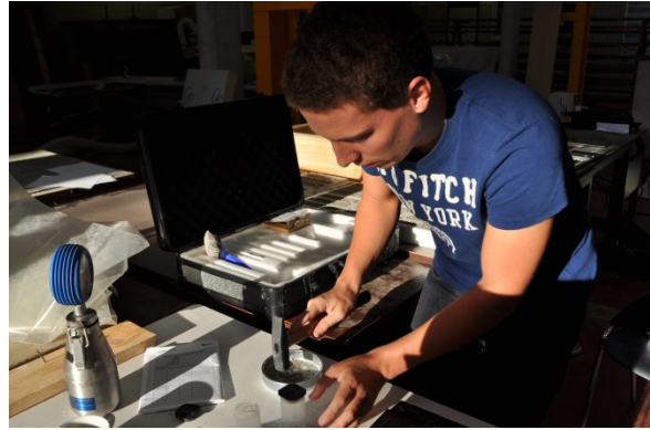
Figuur 58: Verbrijzelen van zandcement proefstaal
