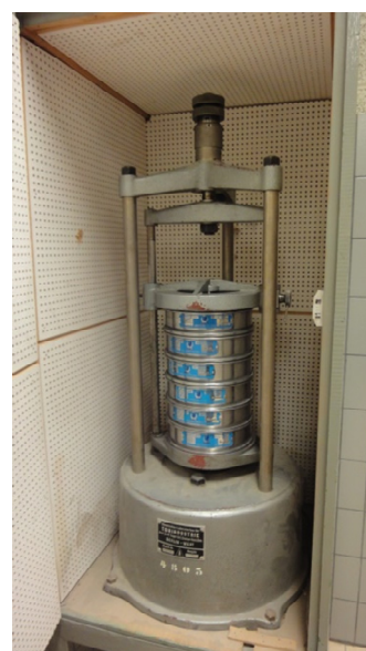
Figuur 69: De ISO-zeven in de trilkast
