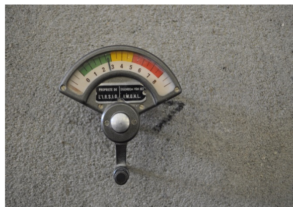
Figuur 65: Meetapparatuur voor diepte ponsinslag te meten in mm
