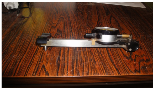
Figuur 32: Onderzijde Demec-toestel
