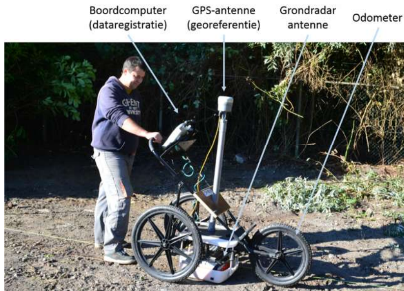
Figuur 6: De mobiele GPR survey configuratie met de GSSI UtilityScan DF GPR-systeem.
