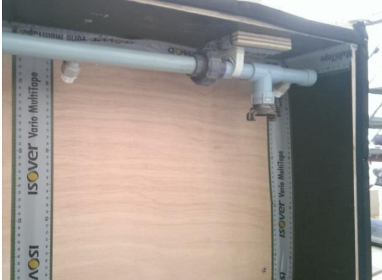
Figuur 104: Bevestiging testelement in luchtdichte kast; testmuur met drukinstallatie en water af- en toevoer; sproeikoppen in een hoek tussen 90° en 120°; opsporen van luchtlekken door middel van rookinstallatie.
