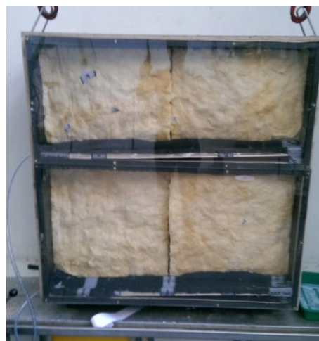
Figuur 105: Achterzijde van kast met goot om water weg te leiden.
