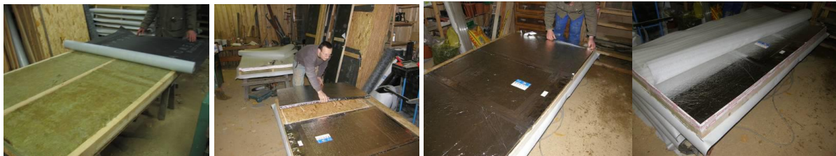
Figuur 34: Samenstelling van de "2-man-panel-unit". [33]
