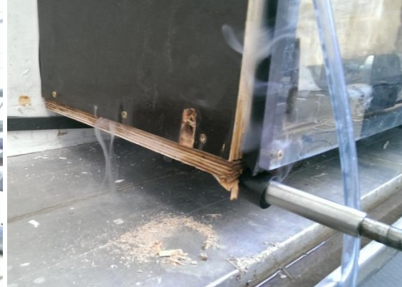
Figuur 104: Bevestiging testelement in luchtdichte kast; testmuur met drukinstallatie en water af- en toevoer; sproeikoppen in een hoek tussen 90° en 120°; opsporen van luchtlekken door middel van rookinstallatie.
