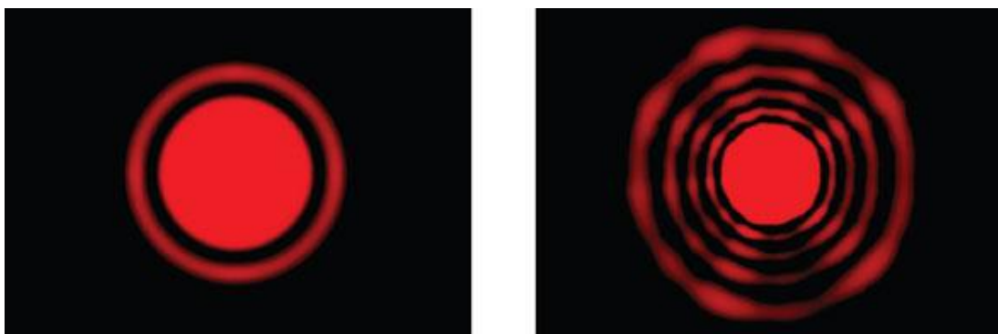
Figuren 17 en 18. Verschillende diffractiepatronen (links: klein deeltje, rechts groot deeltje)
