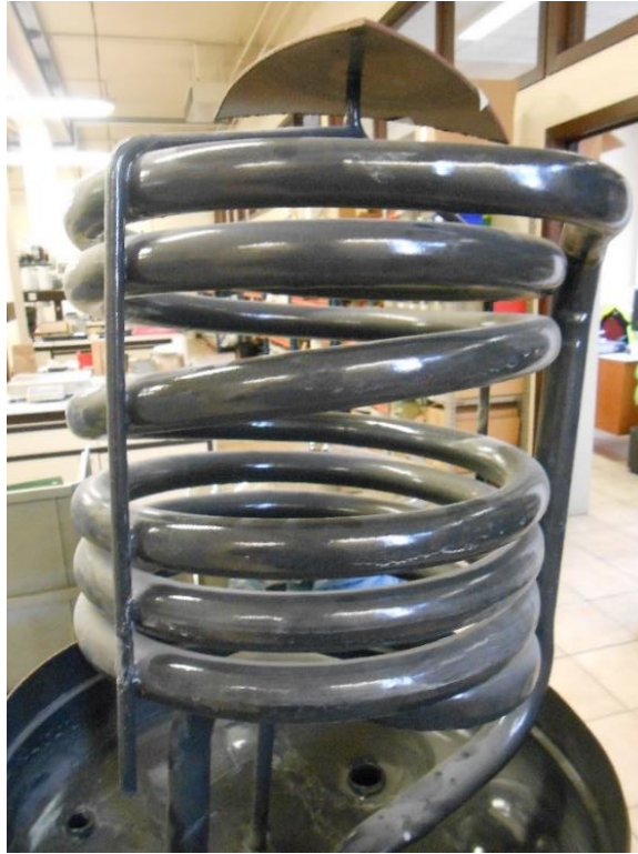
Figuur 7. Binnenkant van een geëmailleerde boiler
