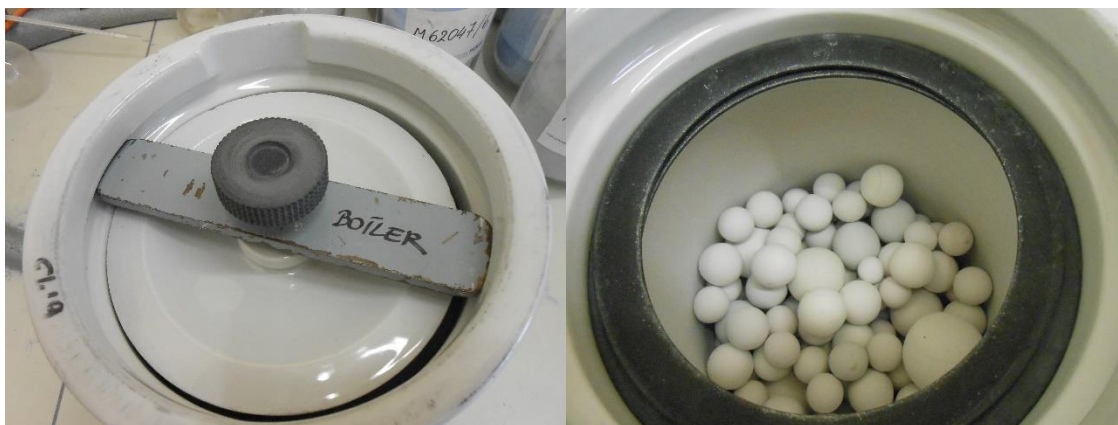
Figuren 22 & 23. Kogelmolen met (links) en zonder (rechts) deksel
