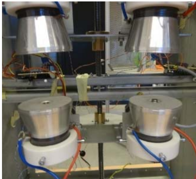
Figuur 7.10: Akoestische levitatie van twee objecten bij gebruik van vier transducers
