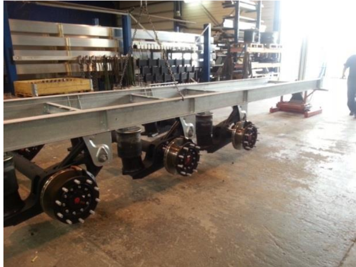
Figuur 7: Vierde fase: draaien frame en plaatsen op steunen
