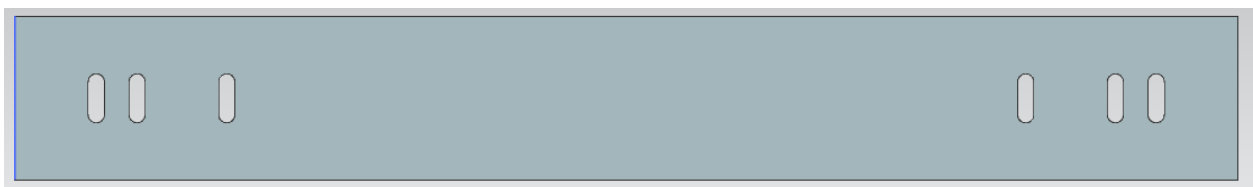
Figuur 73: Bovenaanzicht centreerprofiel met drie paar sleuven
