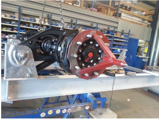
Figuur 4: Constructie op wielnaaf voor weergeven middelpunt en uitlijning (links)
