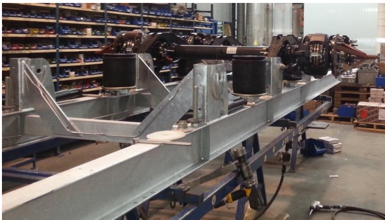
Figuur 38: Omgedraaid hulpframe huidig productieproces
