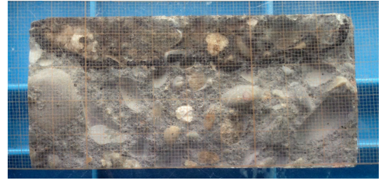
Afbeelding 44: Chloride-indringing in TC
