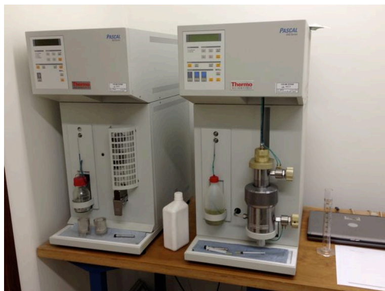
Afbeelding 63: Apparatuur voor MIP-analyse
