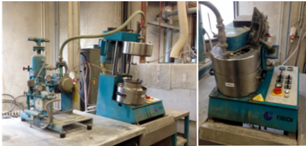
Afbeelding 13: Eirich vacuümmenger R02/VC
