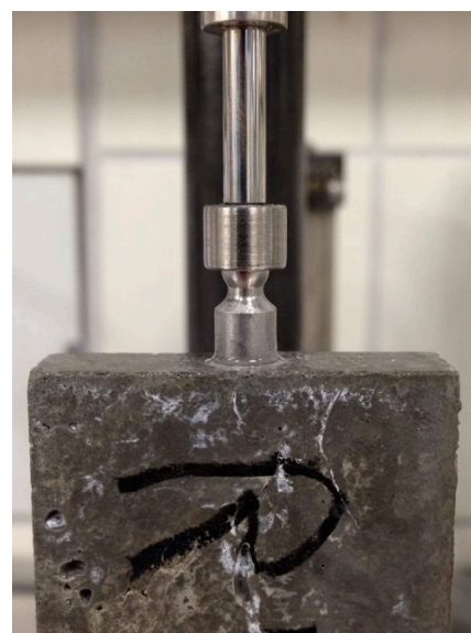
Afbeelding 50: Metalen element ter verbinding met meettoestel
