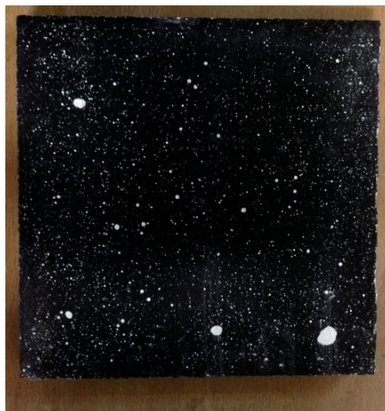
Afbeelding 60: Creatie van contrast op de proefstukken voor luchtholtenanalyse, d.m.v. zwarte inkt en \text{BaSO}_4 -poeder
