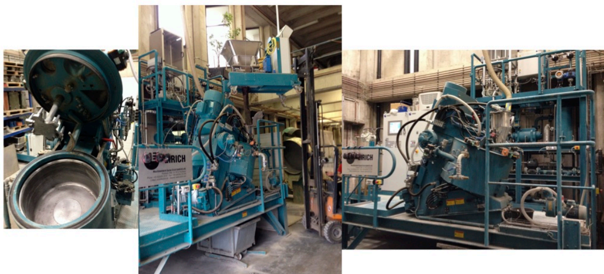
Afbeelding 12: Eirich vacuümmenger R08/VC
