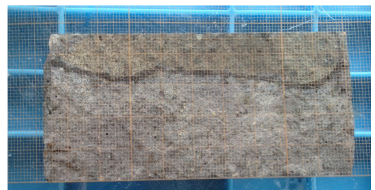
Afbeelding 42: Chloride-indringing in HPC
