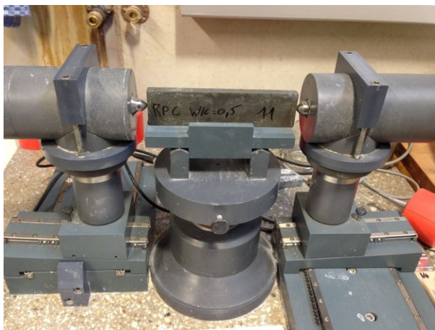
Afbeelding 52: In drie dimensies verstelbare opstelling
