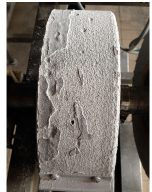
Afbeelding 28: 3RPC1-proefstuk na afborstelen van de losgekomen laag
