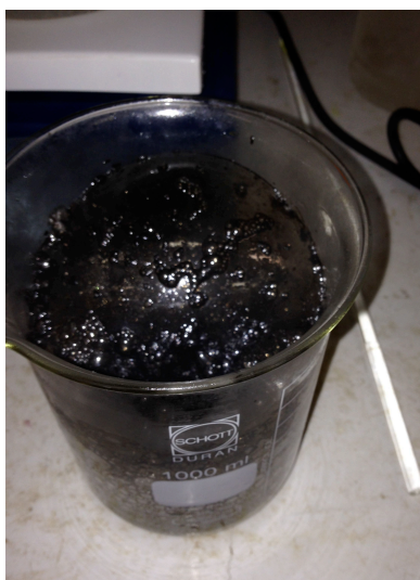
Afbeelding 10: Hevige reactie tussen steenslag en HCl
