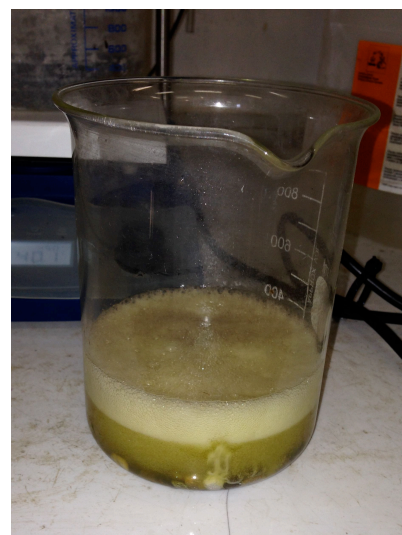
Afbeelding 11: Reactie tussen rolgrind en HCl
