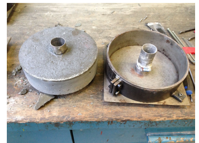
Afbeelding 14: Proefstuk en bekisting voor TAP-toestel
