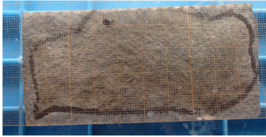
Afbeelding 43: Chloride-indringing in RPC
