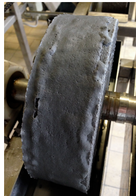
Afbeelding 27: Loskomen buitenste laag op een 3RPC1 proefstuk
