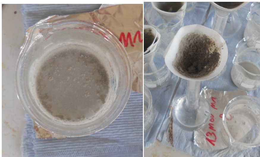
Figuur 4-18: Flocculatie van het poeder tijdens de titraties van met WRA geheelde proefstukken.
