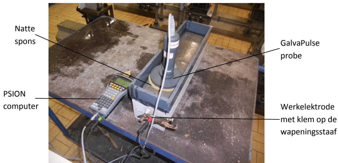
Figuur 3-20: Meetopstelling GalvaPulse tijdens het uitvoeren van een HCP meting.
