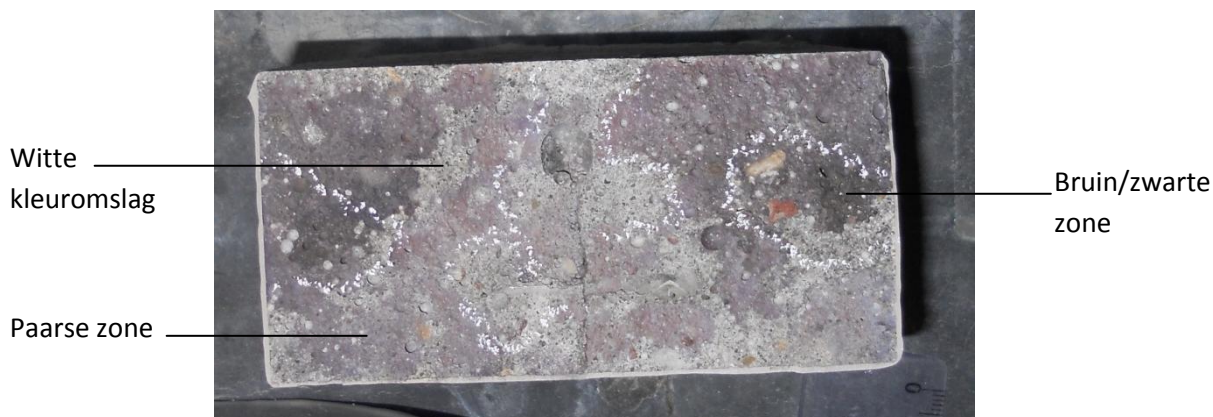
Figuur 4-2: Aftekening op een met WRA geheeld proefstuk na het besprenkelen met \text{AgNO}_3 .
