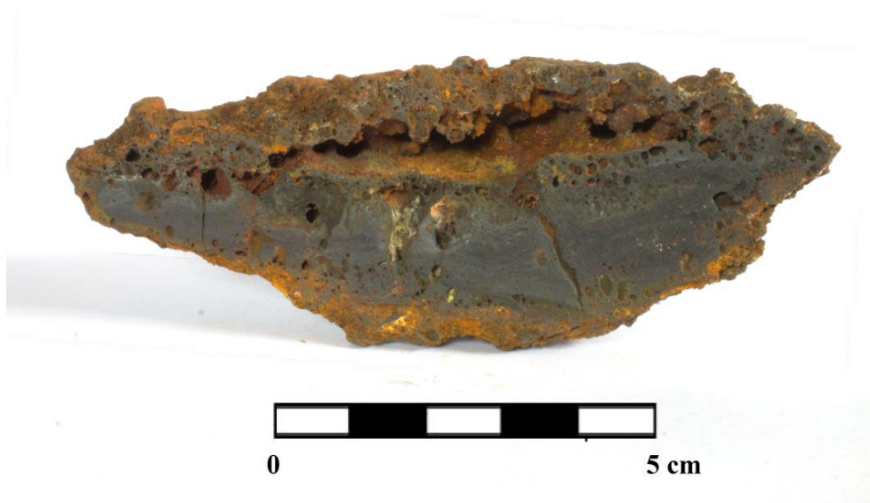
Figuur 15: Afbeelding van de ijzerwolf uit spoor 4 (ksb4_pcb-wolf). De metaalgrijze zone bestaat uit metallisch ijzer.
