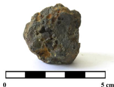
Figuur 19: Monsternr. ksb25_sgd. De verhoogde aluminiumwaarde kan wijzen op een fusie tussen brandstof, ijzer en ovenwand.
