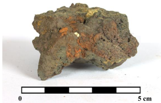
Figuur 26: Afbeelding van de geanalyseerde furnace lining bm3_ws_1. Bemerkt de restanten van de roodgebakken klei op de verglaasde slak.
