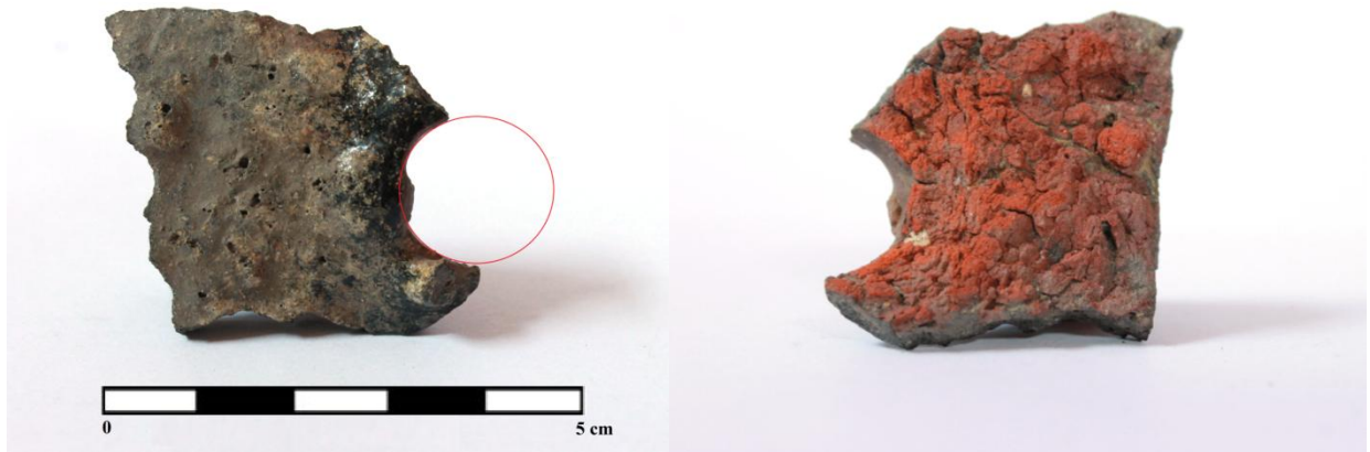
Figuur 25: Voor- (links) en achterzijde van een fragment verglaasde furnace lining (bm2_ws_1). Deze is voorzien van een ronde opening op de plaats waar de tuyère geplaatst zat.
