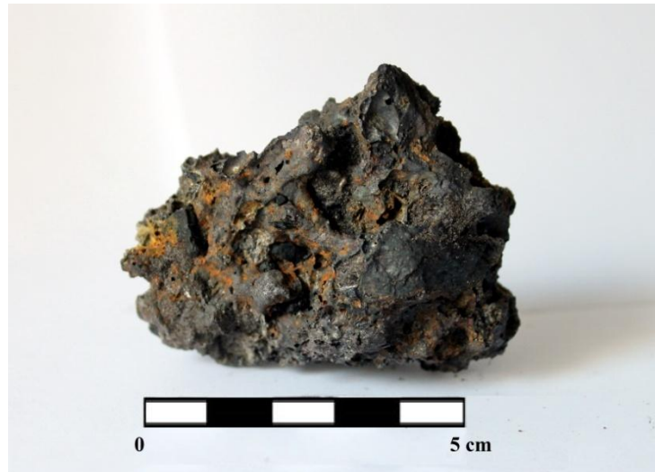
Figuur 16: Voorbeeld van een non-diagnostic slag afkomstig uit spoor 26 (ksb26_nd_1). Bemerkt de fragmenten steenkool vervat in een matrix van ijzeroxide en fayaliet.
