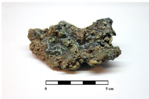
Figuur 3: De bovenzijde van een verglaasde (smeed)ovenwand/ furnace lining . (Melsele-Brielstraat spoor 54 (mls_ws_1))
