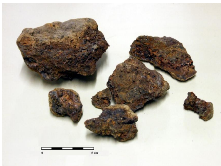
Figuur 27: Afbeelding van de “limoniet” uit spoor SM 91 B91-349 BB8 (2301) 4. Chemische analyse wees uit dat dit echter geen erts is, maar zeer sterk gecorrodeerd ijzer.
