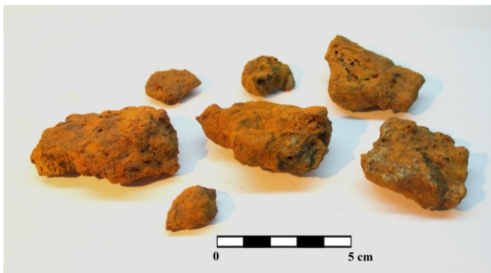
Figuur 30: Afbeelding van enkele smeedslakken van het type SAS uit spoor 314 (mls314_sas).
