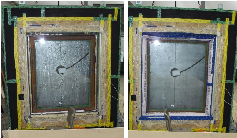
Afbeelding 139 en 140: opstelling zonder en met luchtdichting
