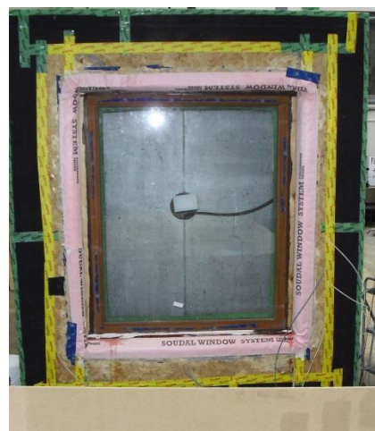
Afbeelding 123 en 124: waterinfiltratie tussen regendichting en raamkader, op de luchtdingsfolie
