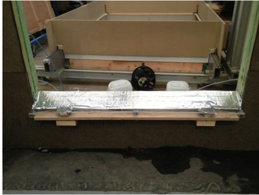
Afbeelding 135 en 136: aanpassing opstelling: gootje en opvang onderaan raamopening, druiplijst boven raam
