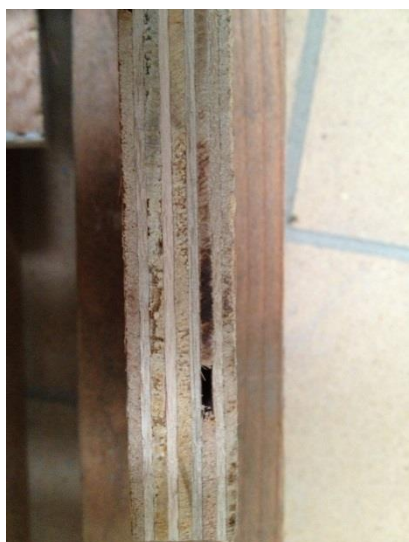
Afbeelding 81: fouten in de fineerlaagjes.
