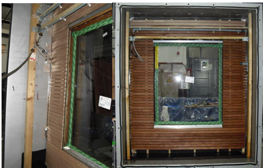
Afbeelding 57: installatie sproeiers in testkast
