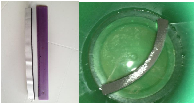
Afbeelding 105 en 106: materiaaltest waterabsorptie van de zwelband: afmetingen proefstuk, onderdompeling
