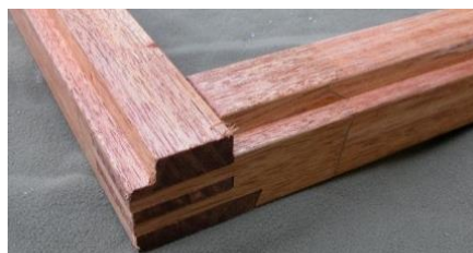
Afbeelding 71: kozijnen in elkaar zetten [65]
