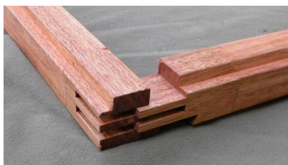
Afbeelding 71: kozijnen in elkaar zetten [65]
