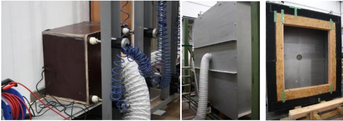
Afbeelding 55: Opstelling aansluiting testwand, stalenkast en testobject
