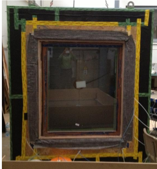
Afbeelding 131: opstelling multiplexkader en luchtdichtingsfolie
