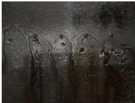
Afbeelding 8: vorming van rivulets aan de bovenzijde van openingen van 4 mm. [13]
