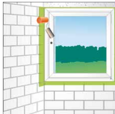
Fig. 4: bevestig het membraan op de muur
