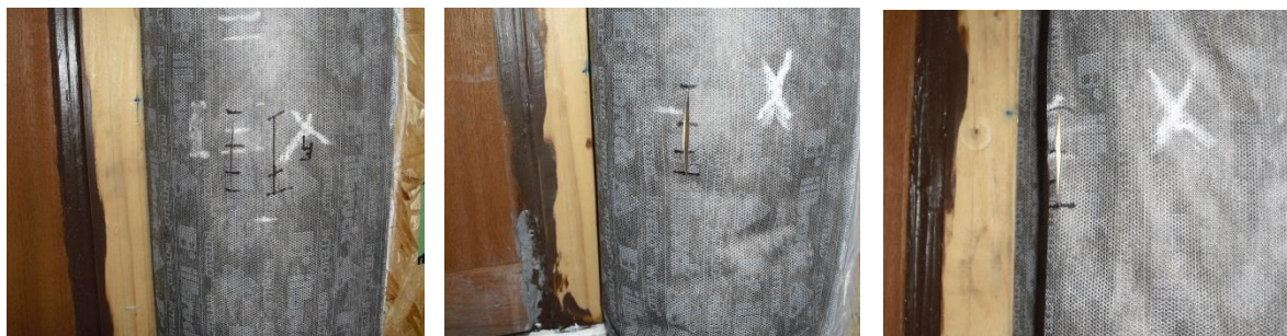
Afbeelding 76: reeks sneede 2 cm en 4 cm: respectievelijk zonder drukverschil, overdruk en onderdruk
