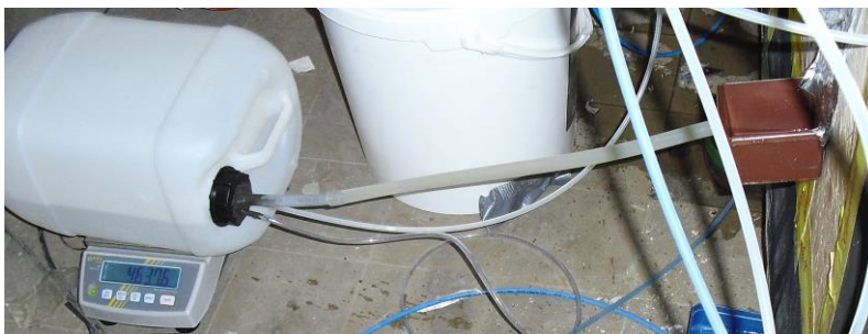
Afbeelding 66: hermetisch gesloten bidon aangesloten op druksensor en druk in aansluiting, wateropvang
