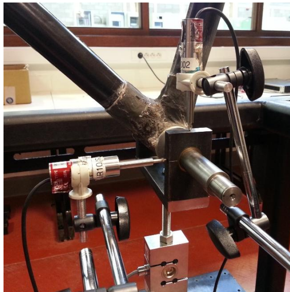
Figuur 6.25: Lvd't's en krachtsensor (onderaan de foto)
