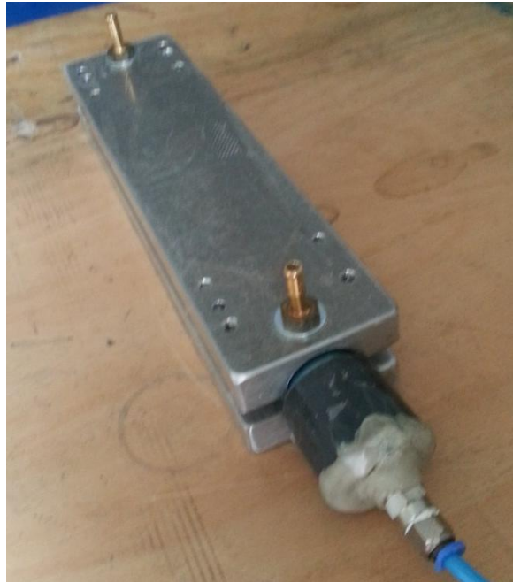
Figuur 5.17: Aluminium buitenmal met blaasbalg en infusie
