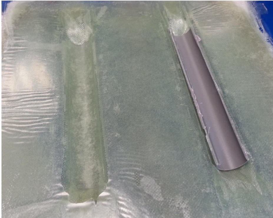
Figuur 5.19: Glasvezelmal met pvc-afdruk
