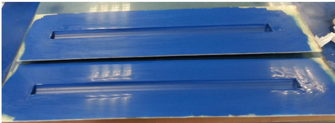
Figuur 5.20: Glasvezelmal met polyester (blauw) afwerking
