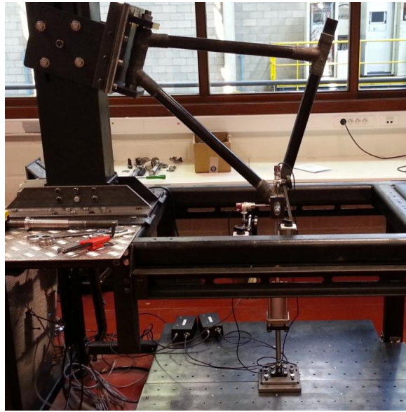
Figuur 6.24: Testopstelling framestijfheid
