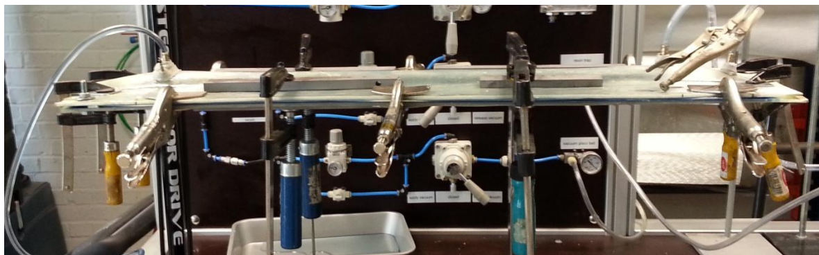
Figuur 5.22: Infusieproces buizen in glasvezelmal
