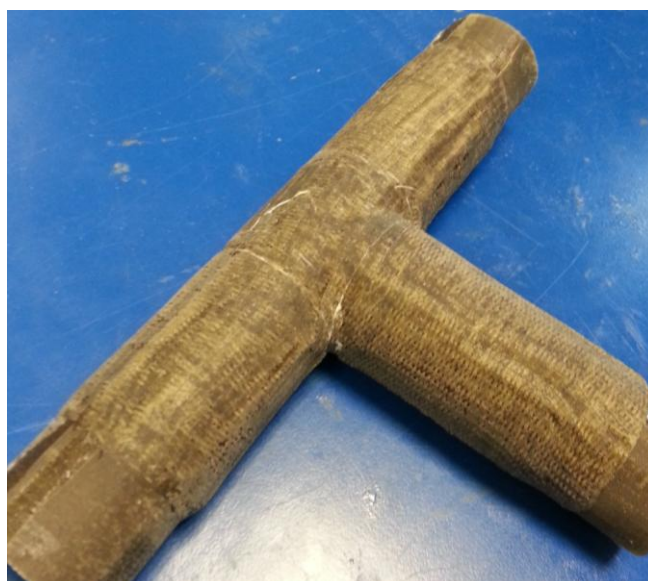
Figuur 5.25: Verbinding door prepreg matten
