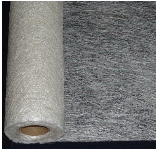
Figuur 2.3: Korte, verhakke glasvezels in een mat
