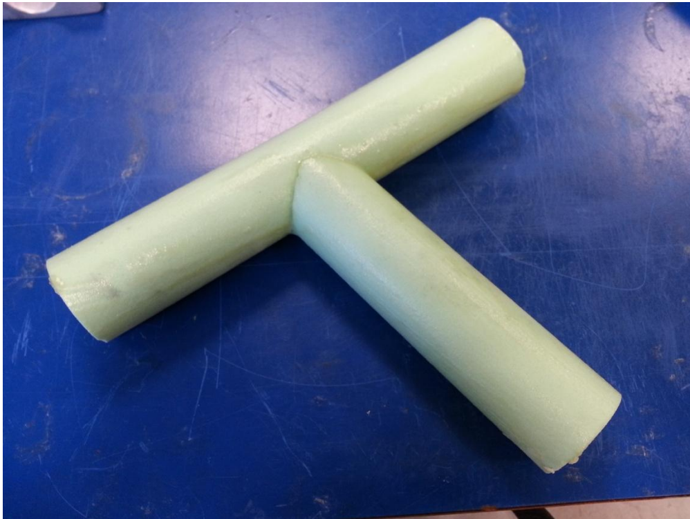
Figuur 5.26: Mal van de lug ingesmeerd met latex
