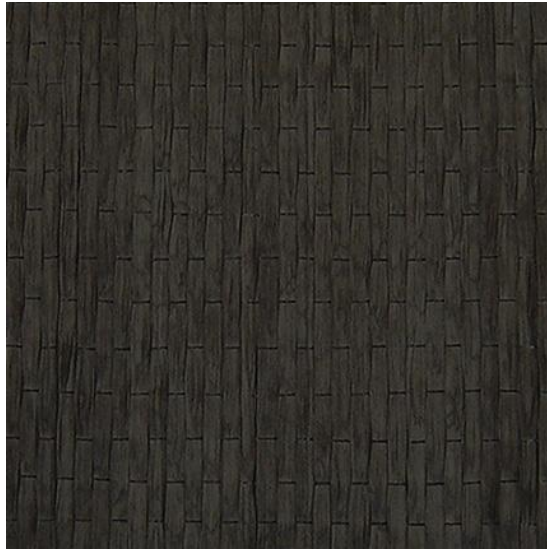
Figuur 2.4: Unidirectionele koolstofvezels samengehouden door fijne draadjes
