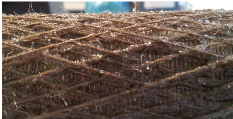
Figuur 5.11: Detail wikkeling getorste vezel, yarn
