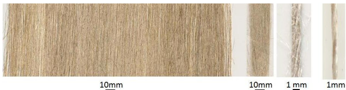
Figuur 3.2: 4 verschillende vlasvezel bundeltypes: (van links naar rechts) non-woven vlas, doubled vlas, roving en yarn [15]
