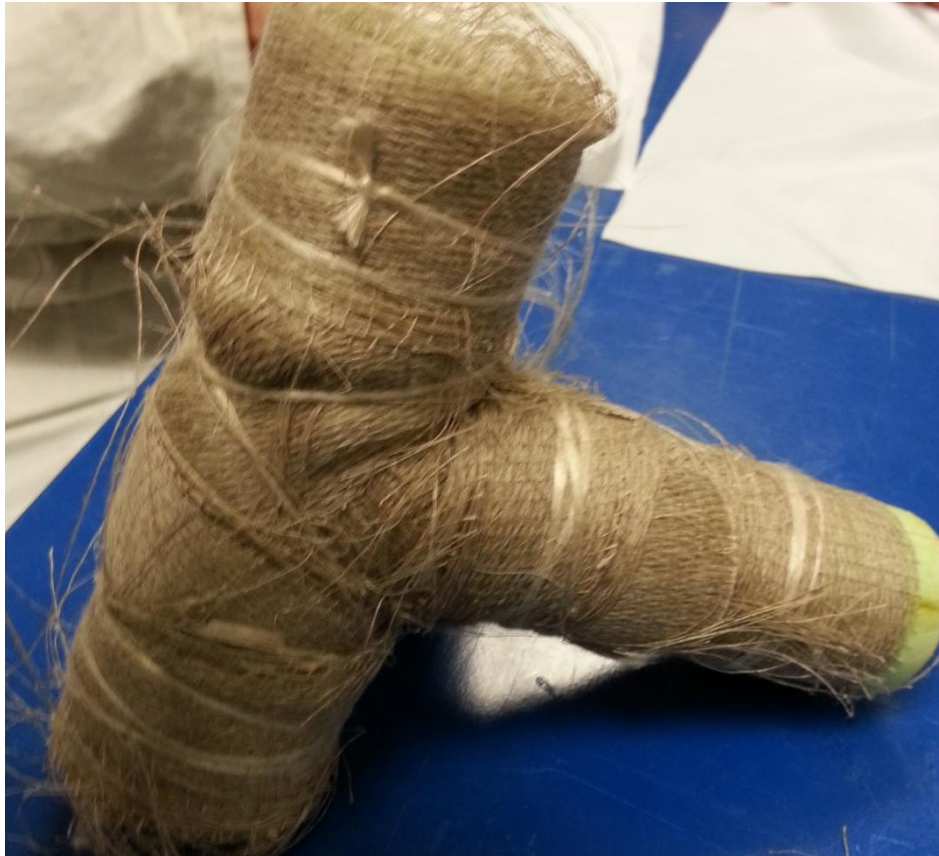
Figuur 5.27: Gedrapeerde mal van een lug
