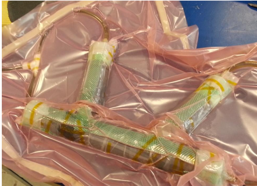
Figuur 5.28: Gedrapeerde lug in vacuümzak
