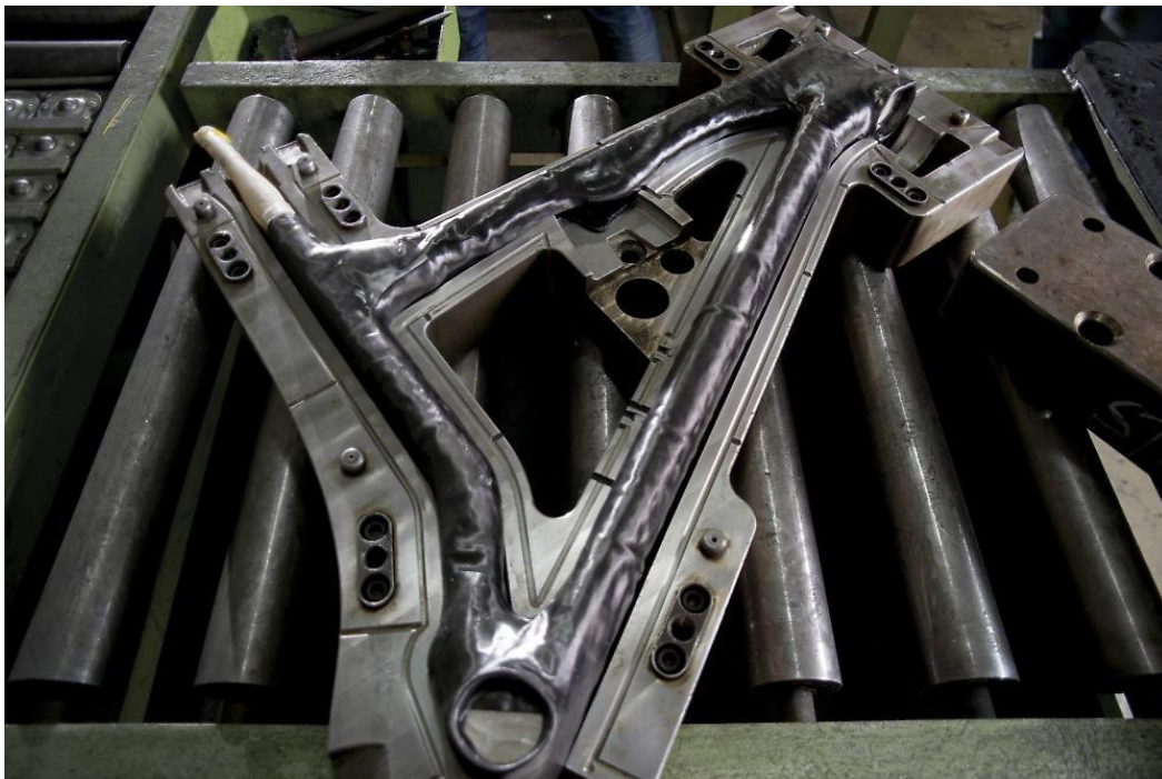
Figuur 3.7: Mal met koolstof prepreg
