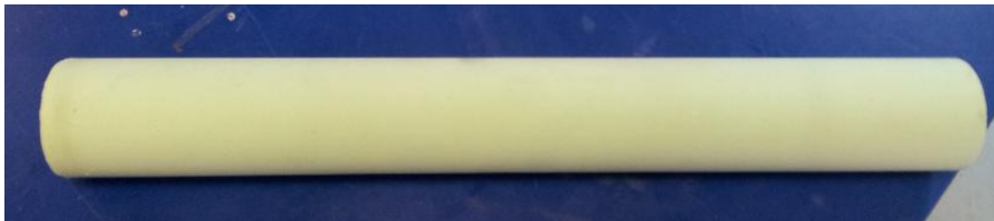
Figuur 5.14: Cilindrische binnenmal uit polyurethaan
