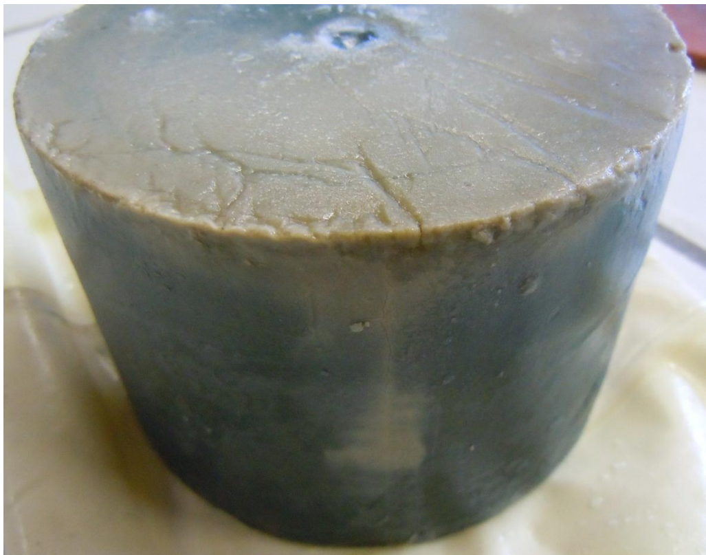
Figuur 63: Scheurpatroon onderzijde en scheur in langsricting (PB-monster)
