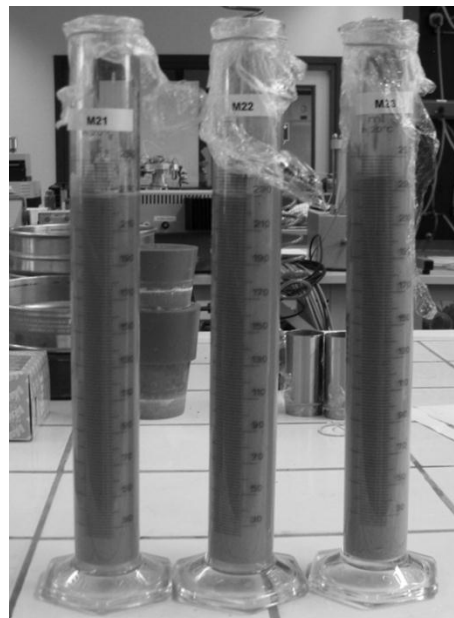
Figuur 35: Bleed -test op drie verschillende proefmengsels
