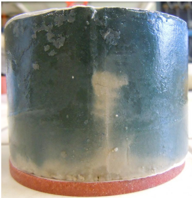
Figuur 61: Duidelijke scheur in langsrichting (PB-monster)
