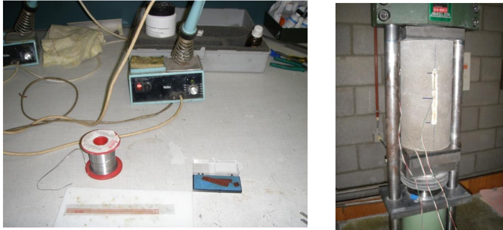
Figuur 21: Voorbereiding en proefopstelling voor de bepaling van de E-modulus
