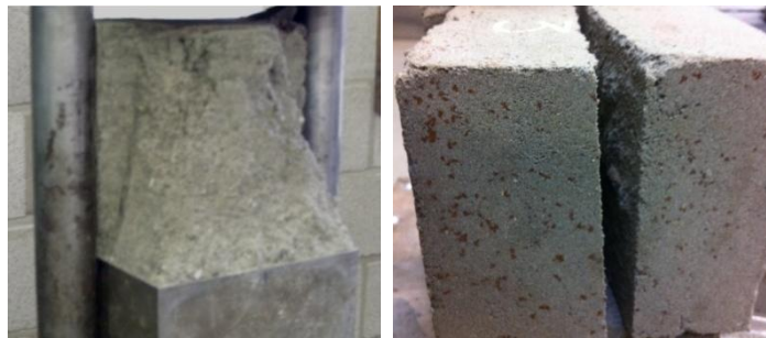
Figuur 74: Verschil in breuk van de kubussen. Links: normaal. Rechts: splijt (foto van HOGent)
