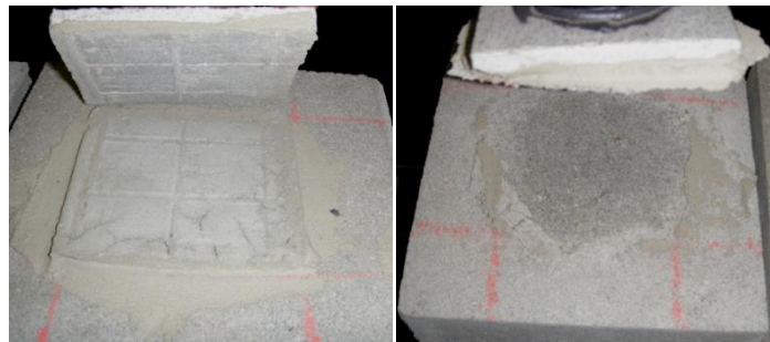
Figuur 71: Breukvlakken bij hechtingsproef zand-cement/lijm/tegel. Links: tegel komt van lijm ("tegel/lijm"). Rechts: breuk zand-cement.
