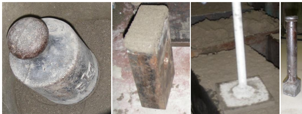
Figuur 11: Verdichtingsgewichten van 5kg (links) en verdichtingsstaven (rechts)
