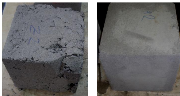
Figuur 73: Mate van verdichting. Links: zwak. Rechts: hard.
