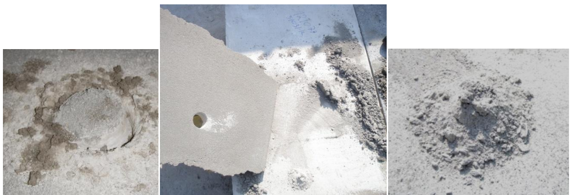
Figuur 48: Poging tot boren. Links: Onmogelijk mooie cilinder te verkrijgen. Midden: Plaat komt in zijn geheel los (geen hechting). Rechts: Puin ten gevolge van boren in zand-cement.
