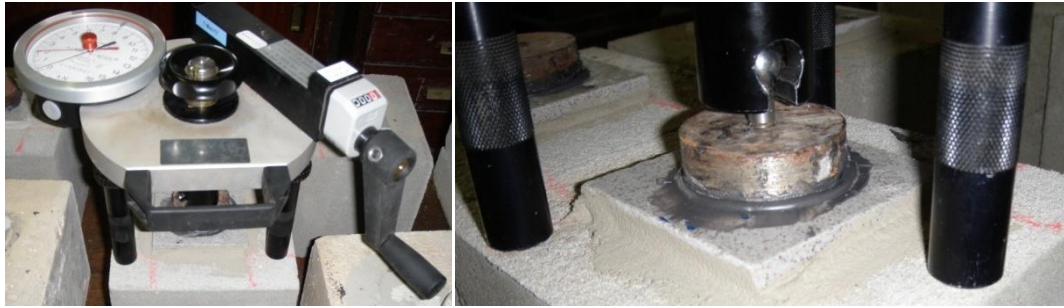
Figuur 70: Proefopstelling voor hechting van een gelijmde tegel op zand-cement
