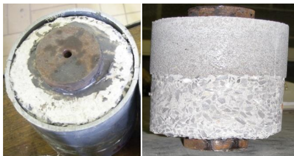
Figuur 59: Links: trekschijf op beton. Rechts: ontkist proefstuk met zowel boven als onder een trekschijf
