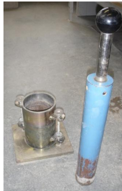
Figuur 32: Proctorproef: links de stalen mal, rechts de hamer
