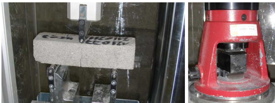
Figuur 17: Buig- en drukproef op kleine prisma's
