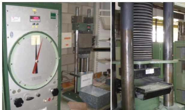
Figuur 12: Kleine pers (tot 200kN) en grote pers voor drukproeven
