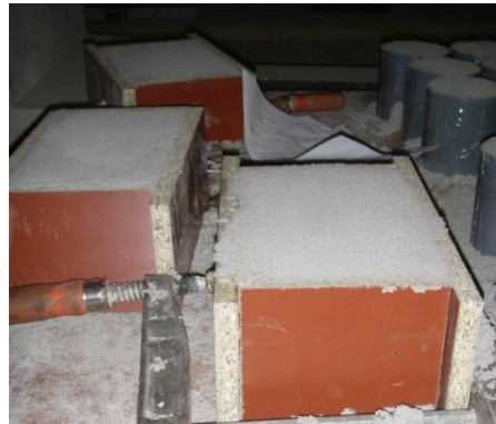
Figuur 51: Extra proefstukken met houten bekisting
