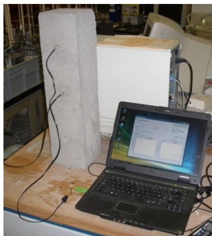
Figuur 27: Proefopstelling vochtmeting
