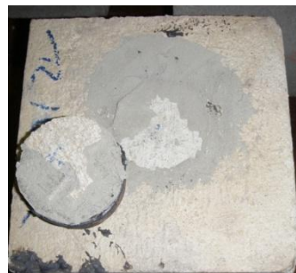
Figuur 72: Breuk bij hechtingsproef van een gelijmde tegel op een betonnen kubus
