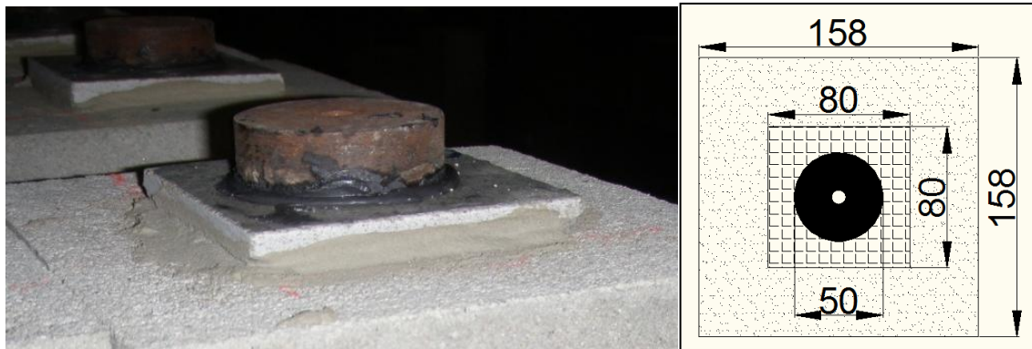
Figuur 69: Proefstuk van de hechtingsproef. Links: foto. Rechts: Schematisch bovenaanzicht
