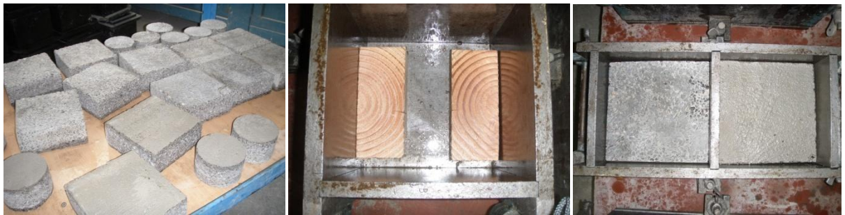
Figuur 49: Betonnen platen, houten steunblokjes en stalen mal vóór aanbrengen van het zand-cement
