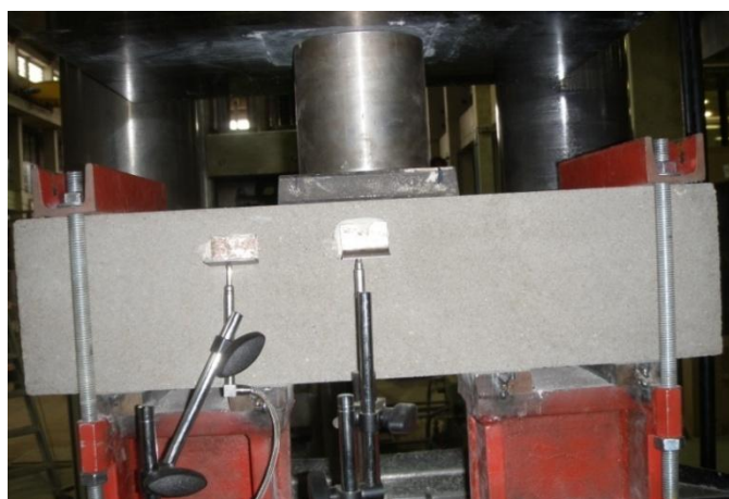
Figuur 36: Afschuiving, proefopstelling van ir. Tim Soetens
