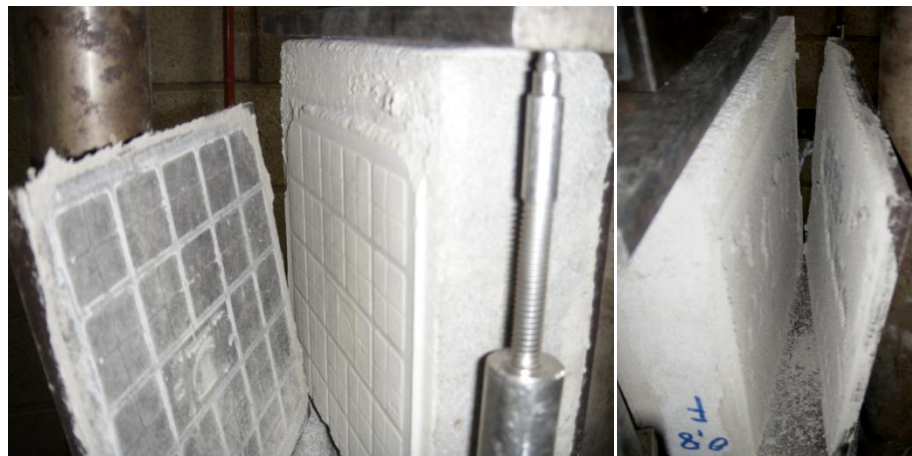
Figuur 65: Breuk na afschuiving met links het breukvlak "lijm/tegel" en rechts het breukvlak in de lijm
