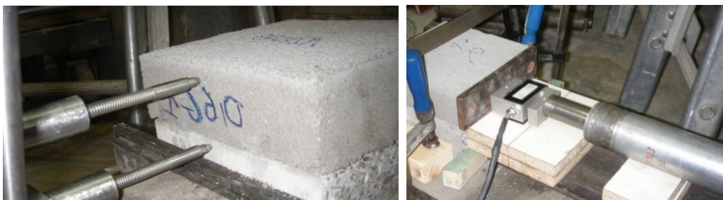
Figuur 54: Links: detail lvd't's. Rechts: Detail vijzel met meetcel en stalen verdeelplaat
