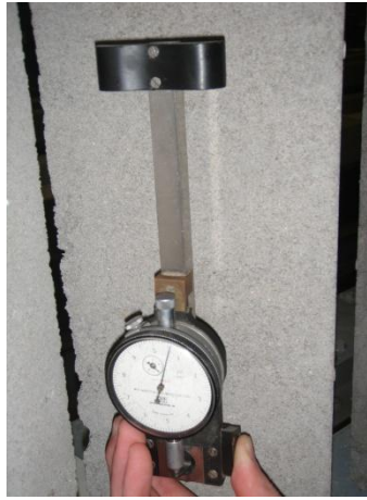
Figuur 25: Meting van de krimp met het Demectoestel
