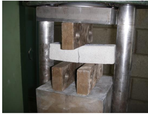
Figuur 35: Afschuiving, proefopstelling: met kleine prisma's
