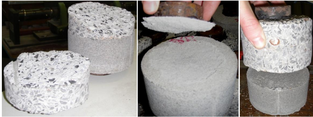
Figuur 61: Breuk bij hechtingsproef. In beton (links), in zand-cement (midden) of in de hechtingslaag (rechts)
