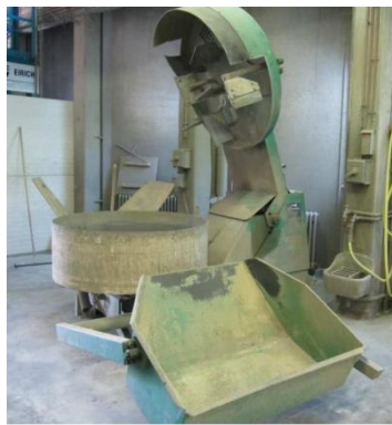
Figuur 9: Menginstallatie laboratorium Magnel
