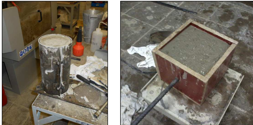
Figuur 15: Voorbeelden van gevulde bekistingen (links: E-modulus en rechts: pull-out)
