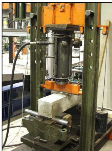
Figuur 10: Principe buigproef
