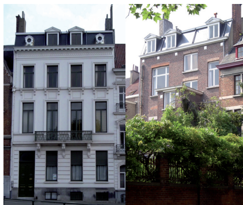
Fig 36. Groot herenhuus waarbij de voorgevel voorzien werd van gedecoreerd pleisterwerk en het metselwerk van de achtergevel naakt bleef
