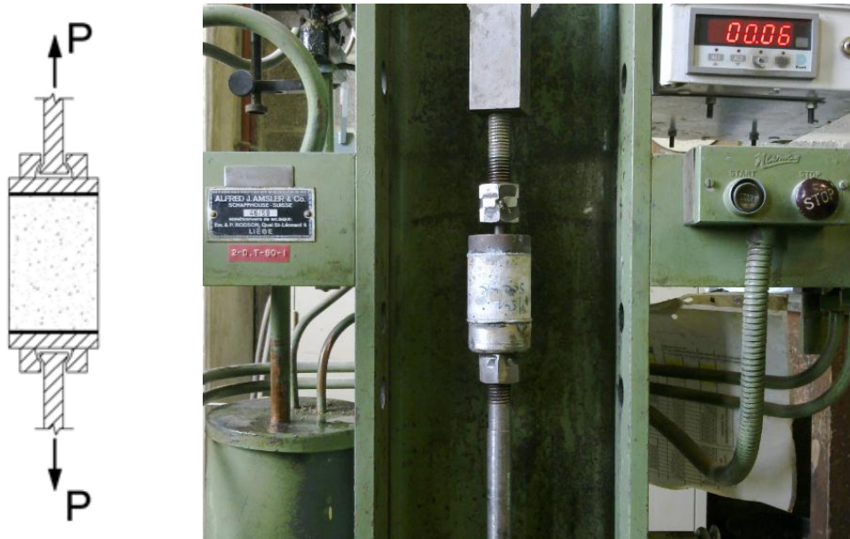
Figuur 3-1: Opstelling rechtstreekse trekproef (Links: schematisch, rechts: Laboratorium Magnel)
