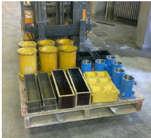
Figuur 6-6: Enkele van de bekistingen (uit kunststof, hout en staal)
