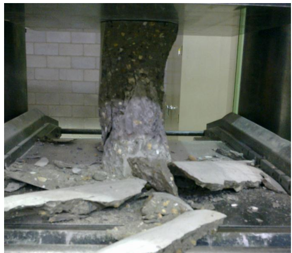
Figuur 6-12: Drukproef op cilinder: explosieve breuk bij betonmengeling SCC-W/C
