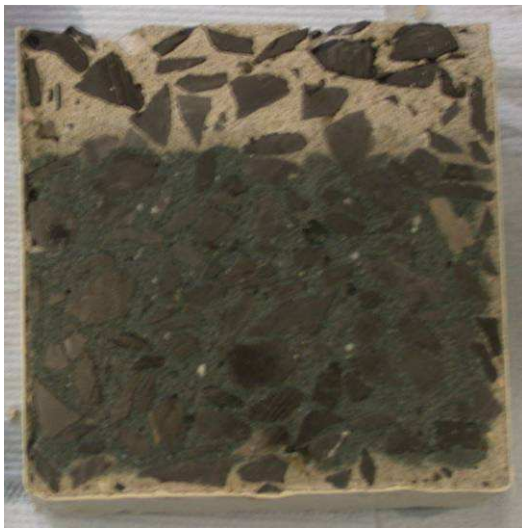
Figuur 60: Verbleekte zone na 2 weken blootstelling van alkali-geactiveerd slakkenbeton aan een omgeving met 10 vol.% CO 2
