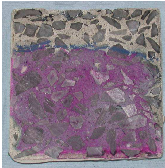
Figuur 58: Gecarbonateerde zone, na 3 weken blootstelling van alkali-geactiveerd slakkenbeton aan een omgeving met 10 vol.% \text{CO}_2
