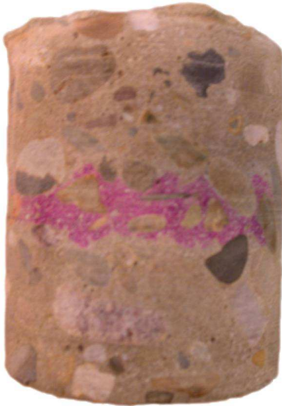
Figuur 28: Carbonatatiediepte kern 1A
