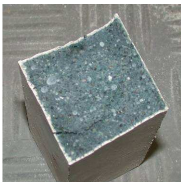
Figuur 36: Foto's van de doorsnede van de cementmortelprisma's na 28 dagen, bij bewaring onder water en 20°C (1), bij >95% RV en 20°C (2) en bij 60% RV en 20°C (3)
