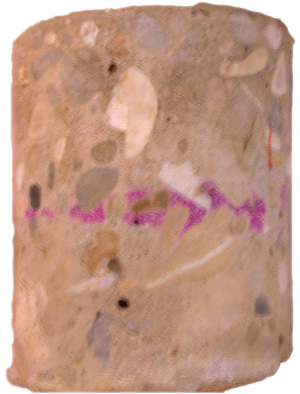
Figuur 29 Carbonatatiediepte kern 1B
