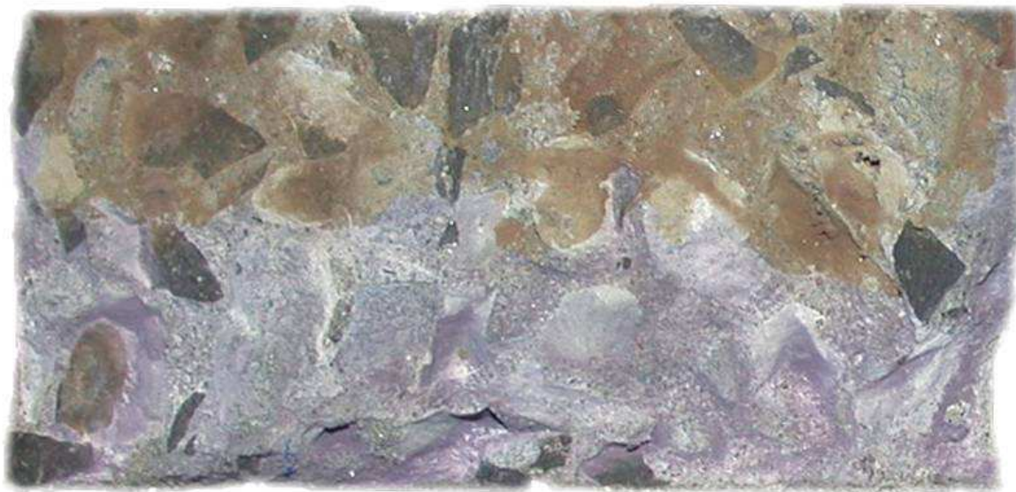
Figuur 55: Chloride-indringing na CTH proef bij Portland cementbeton BP
