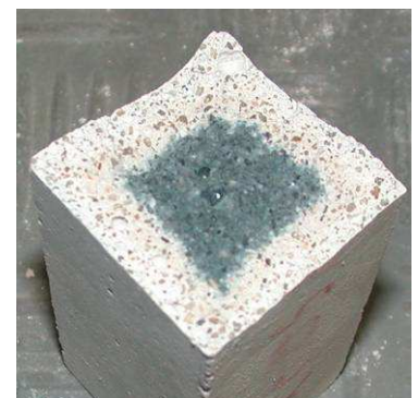
Figuur 36: Foto's van de doorsnede van de cementmortelprisma's na 28 dagen, bij bewaring onder water en 20°C (1), bij >95% RV en 20°C (2) en bij 60% RV en 20°C (3)
