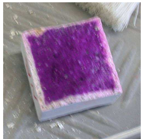
Figuur 37: Foto's van de doorsnede van de cementmortelprisma's na 28 dagen, bij bewaring >95% vochtigheid (2) en in normale atmosferische omstandigheden (3) na bespuiten met fenolftaleïne
