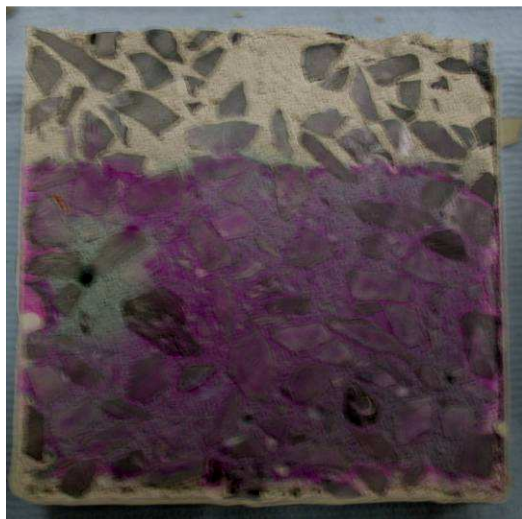
Figuur 62: Gecarbonateerde zone na 2 weken blootstelling van alkali-geactiveerd slakkenbeton aan een omgeving met 10 vol.% CO 2
