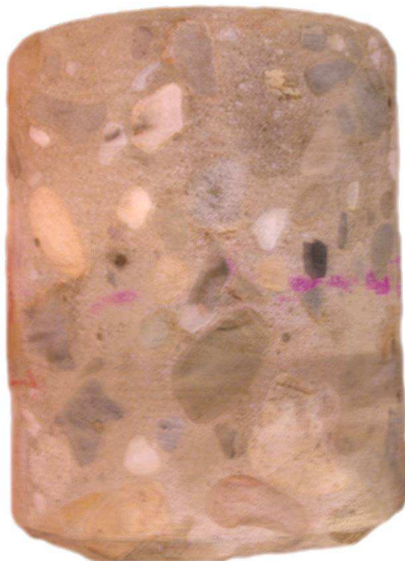
Figuur 30: Carbonatatiediepte kern 2A
