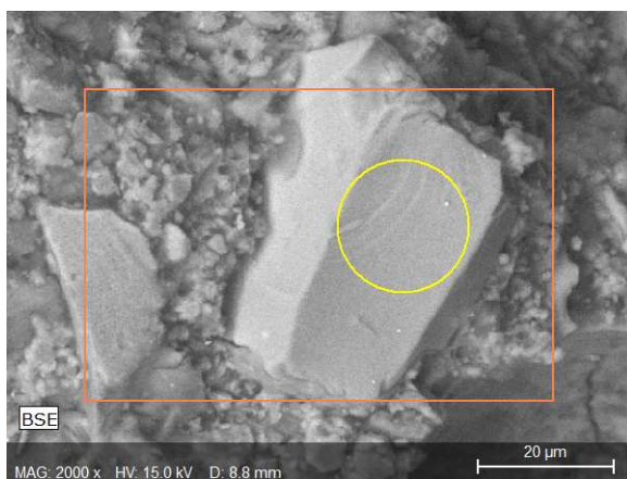
Figuur 23: Beeld SEM: slakkorrel in beton van kolom op verdiep 4 van ‘Parking 58’
