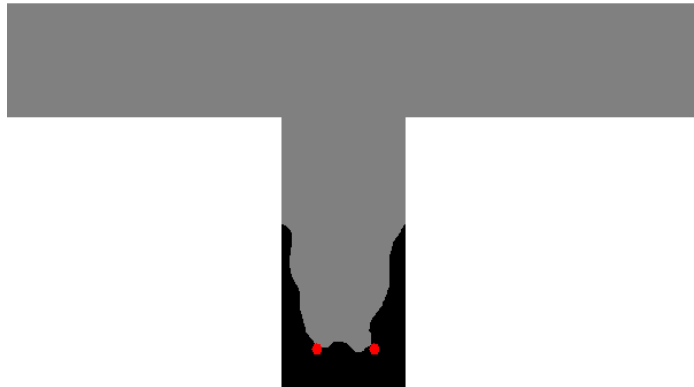
Figuur 16: Weggekapte beschadigde zone van de balk in het balkenrooster
