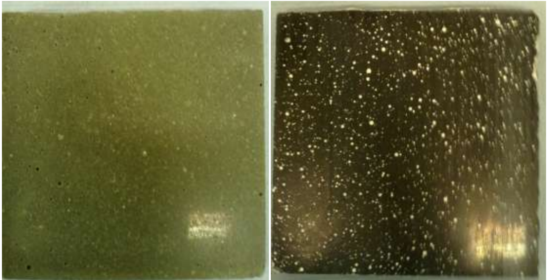
Figuur 30: Voorbereiding gepolijst proefstuk met zwarte inktstift en BaSO 4 -poeder
