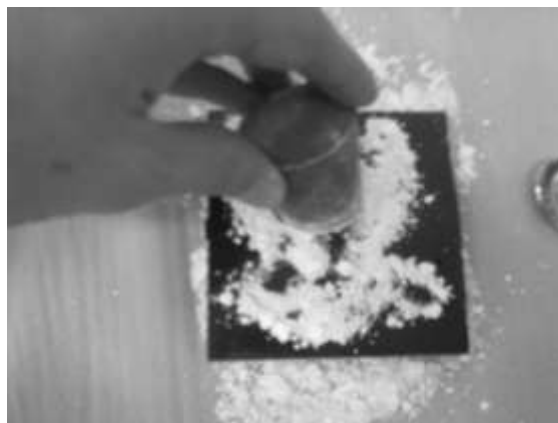
Figuur 29: Poeder aandrukken met rubberen stamper
